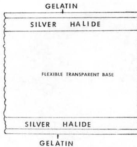
รูป 2.7 (9) แสดงภาคตัดขวางของฟิล์มรังสีเอกซ์ชนิดเอเอ
