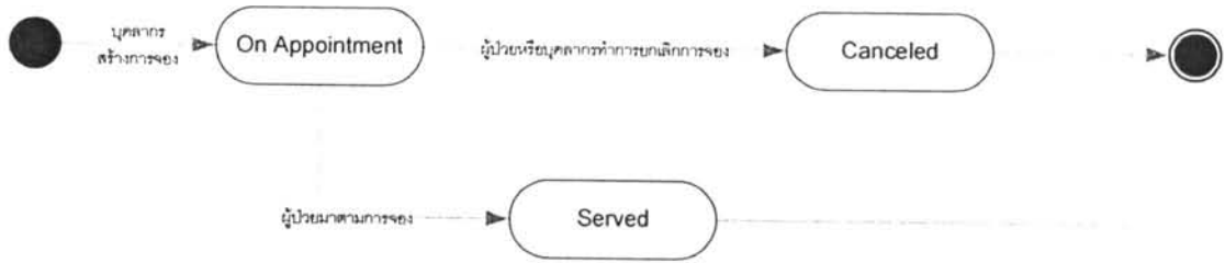
รูปที่ 3.25 State Chart Diagram ของสถานะการจองเตียง (Bed Reservation Status)
