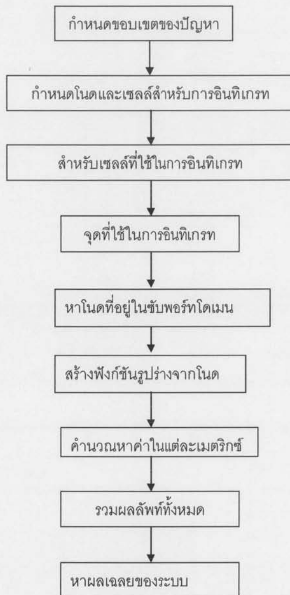
รูปที่ 2.23 อัลกอริทึมของระเบียบวิธีอีลีเมนต์ฟรังกาเลอร์คิน
