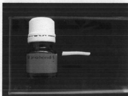
รูปที่46 แสดงการทำเส้นใยแก้วด้วยสารไซเลน
