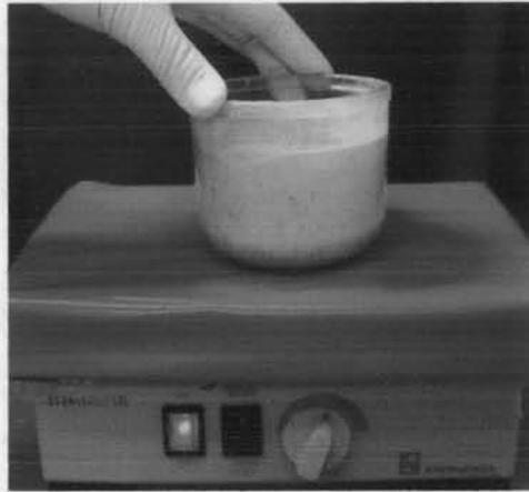
ภาพที่ 7 แสดงใช้เครื่องสั่นเพื่อลดปริมาณฟองอากาศ
