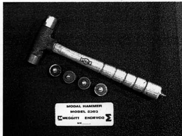
รูปที่ 4.2 Impact hammer สำหรับการทดสอบของ ENDEVCO Model 2303
