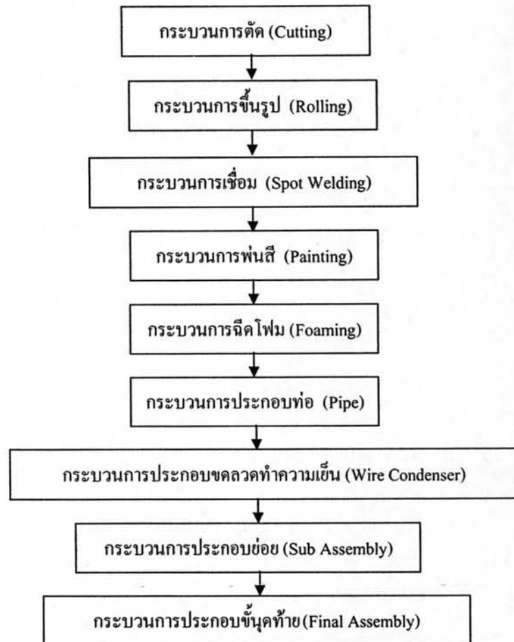
รูปที่ 1.4 แสดงลำดับขั้นตอนกระบวนการผลิตหลัก
