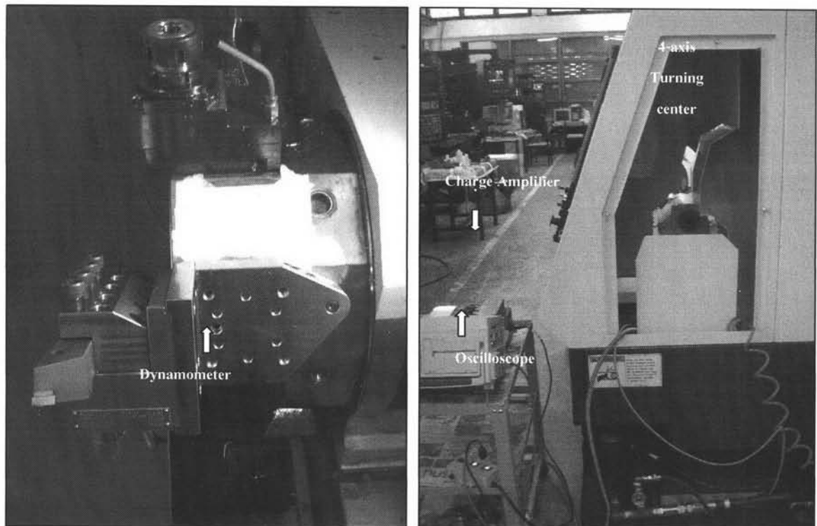
รูปที่ ก.2 แสดงการติดตั้งไดนามอมิเตอร์สำหรับการวัดและวิเคราะห์แรงตัดบนเครื่องกลึงซีเอ็นซี
