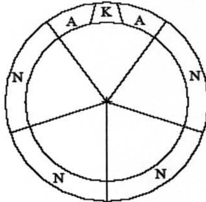
รูปที่ 2.2 หน้าตัดองค์ประกอบของชิ้นส่วนดาดอุโมงค์ใน 1 วง
