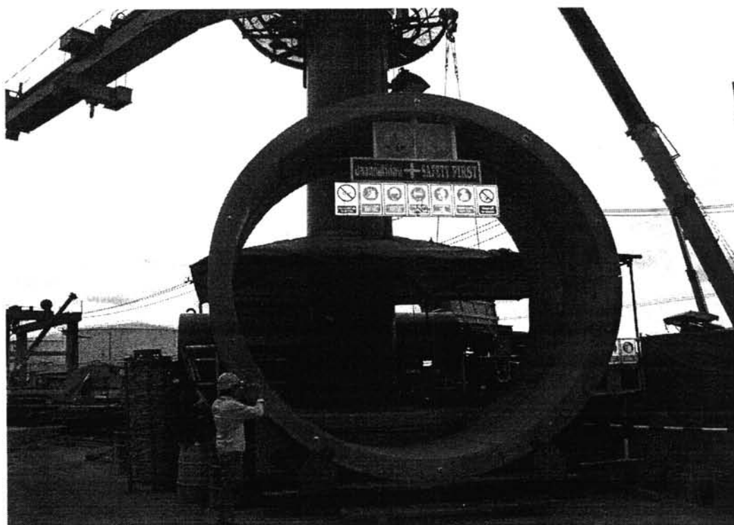
รูปที่ 2.22 แสดงลักษณะอุโมงค์เมื่อทำการประกอบเสร็จ
