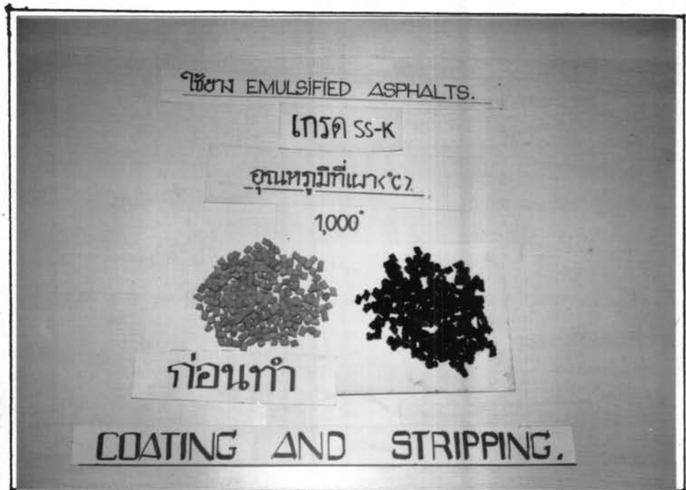
รูปที่ จ.9 การเคลือบผิววัสดุเบ็ดหินเผาแบบแห้งที่อุณหภูมิเผาสุดท้าย 1000^{\circ}\text{C} ด้วยยางแอสฟัลท์อิมัลชันเกรด SS-K
