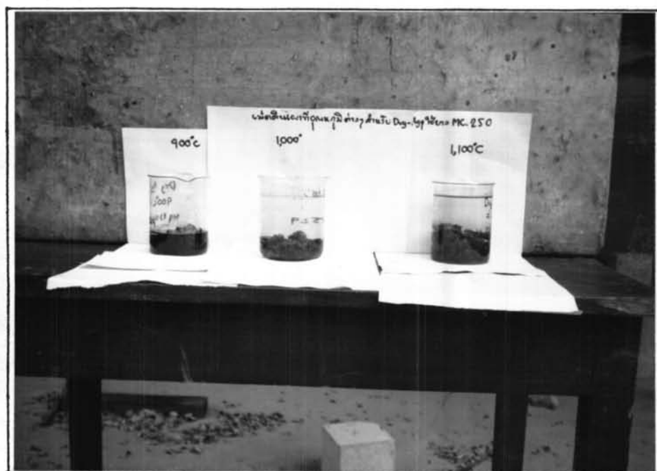
รูปที่ จ.6 การเคลื่อนวัสดุเม็ดหินเผาแบบแห้ง ที่อุณหภูมิการเผาสุดท้าย ต่าง ๆ ด้วยยางคัทแบ็คแอสฟัลท์ เกรด MC-250
