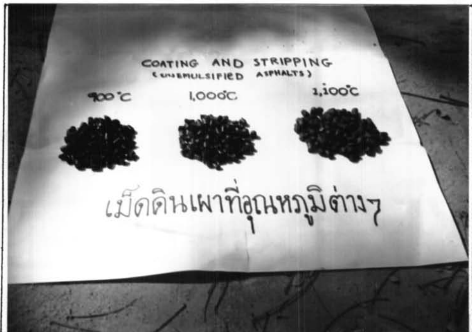
รูปที่ ๙.๘ การเคลือบผิววัสดุเม็ดดินเผาแบบแห้ง ที่อุณหภูมิการเผาสุดท้ายต่าง ๆ ด้วยยางแอสฟัลท์อิมัลชัน เกรด CM-K
