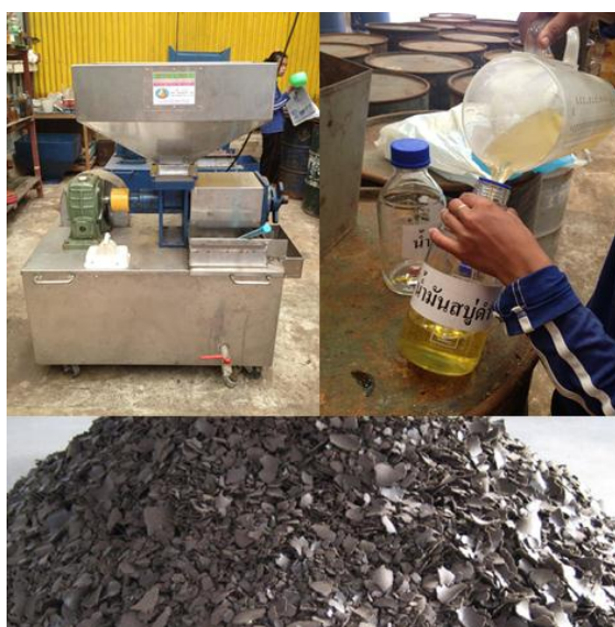
ภาพที่ 2.2 (บนซ้าย) เครื่องคั้นน้ำมันสบู่ดำ (บนขวา) น้ำมันสบู่ดำ (ล่าง) กากเมล็ดสบู่ดำ
