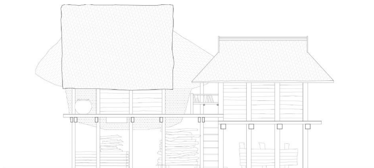
ภาพที่ 5-5 ภาพแสดงรูปด้านของเรือนลัวะดั้งเดิม ด้านที่มีชายคายื่นจรดกับกำแพงดิน
