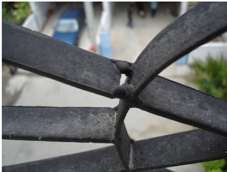
ภาพที่ 5.9 รอยเชื่อมไม่ได้ขนาดตามที่กำหนด
