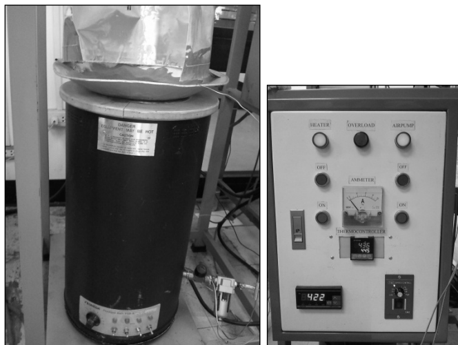
รูปที่ 3.1 อ่างทรายฟลูอิดไดซ์สำหรับให้ความร้อน และแผงควบคุมอุณหภูมิ
