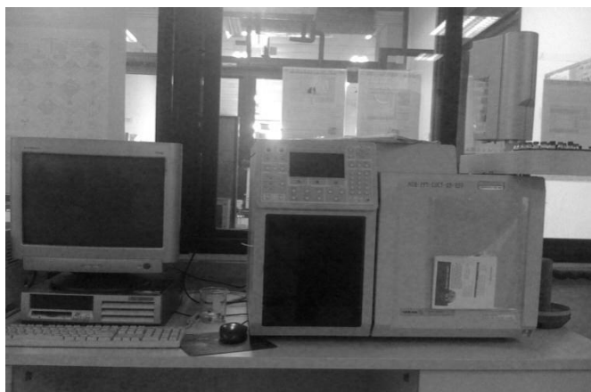
รูปที่ 3.3 เครื่องแก๊สโครมาโทกราฟ รุ่น CP-3800 ของ varian
