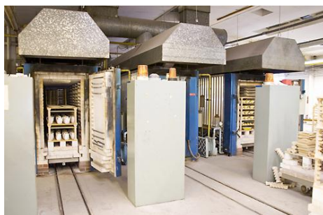
รูปที่ 2.11 แสดงลักษณะของเตาเผาแบบต่อเนื่อง (WEDGWOOD, 2012)
