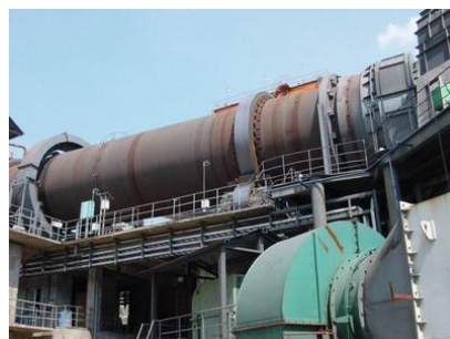
รูปที่ 2.13 แสดงลักษณะของเตาเผาแบบหมุน (Technologys, 2014)
