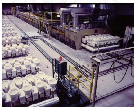
รูปที่ 2.12 แสดงลักษณะของเตาเผาแบบต่อเนื่อง (Dressler.)
