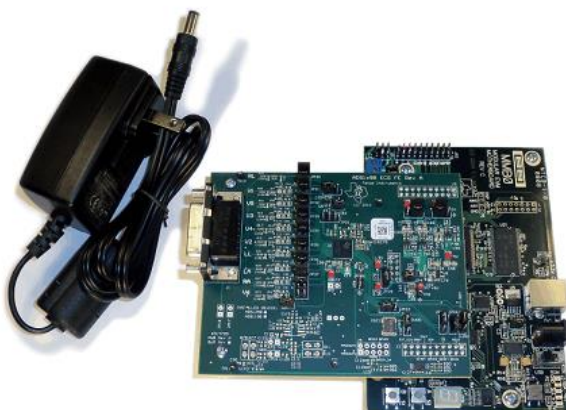
รูปที่ 4.2 ลักษณะภายนอกของบอร์ดทดลองรุ่น ADS1298RECG-FE [48]
