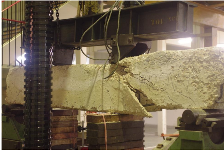
รูปที่ 5-60 การวิบัติของคาน B120W
