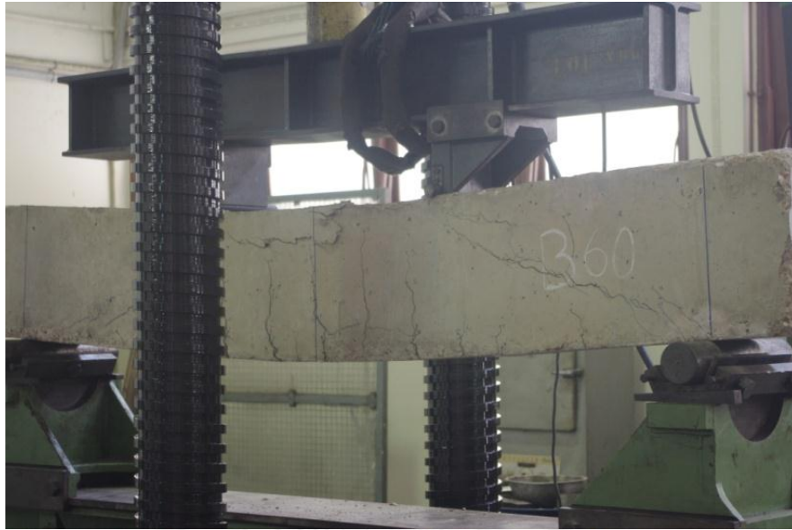
รูปที่ 5-48 การวิบัติของคาน B60
