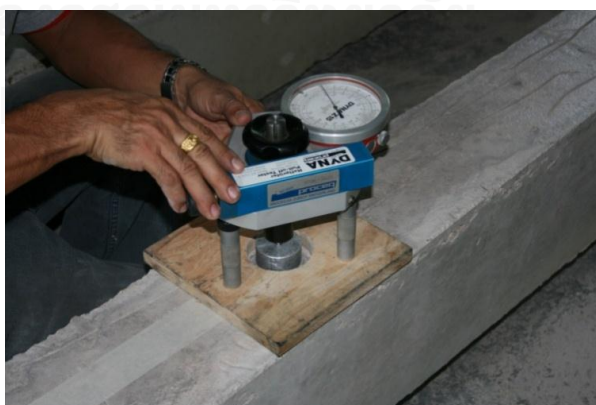
รูปที่ 4-9 การทดสอบการรับแรงดึงของคอนกรีต (Pull out test)
