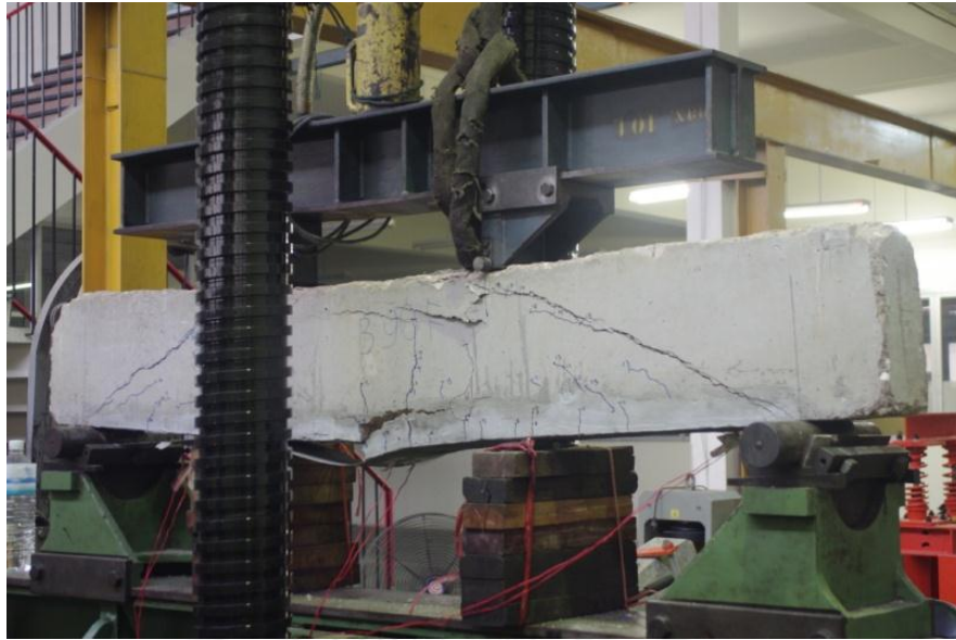
รูปที่ 5-54 การวิบัติของคาน B90F
