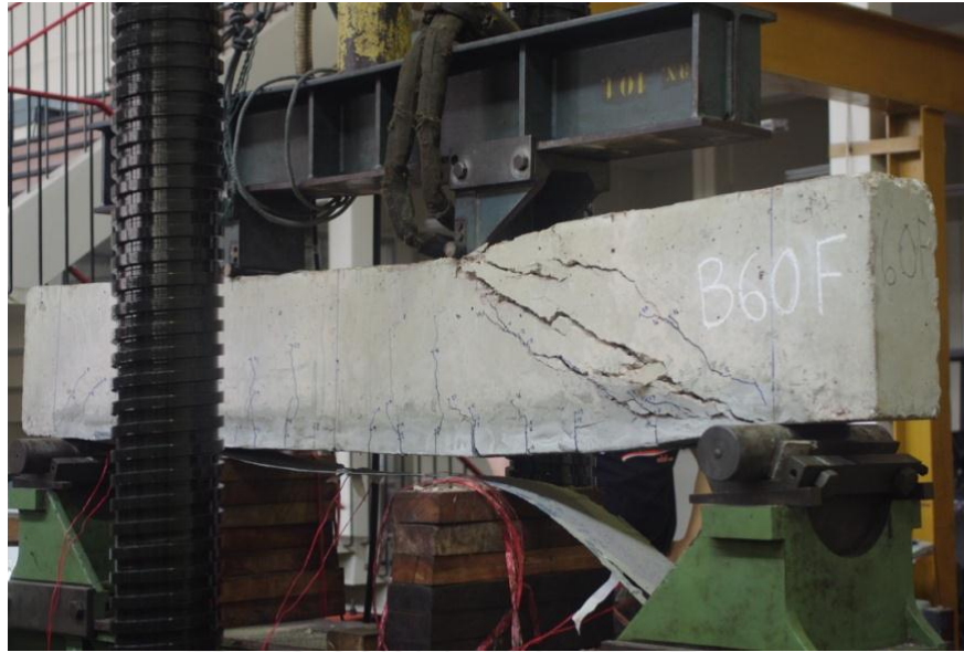
รูปที่ 5-50 การวิบัติของคาน B60F
