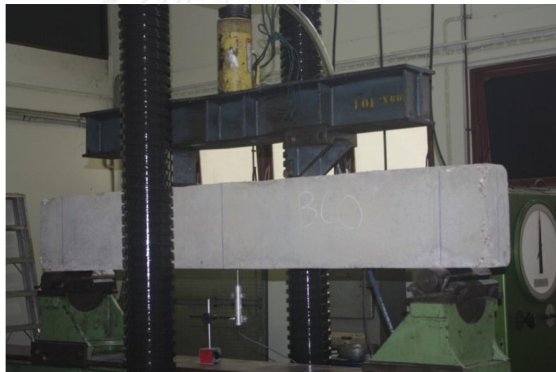
รูปที่ 4-13 การทดสอบคานในห้องปฏิบัติการ
