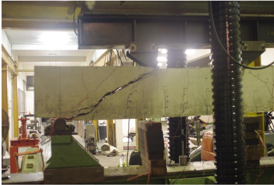
รูปที่ 5-44 การวิบัติของคาน B00
