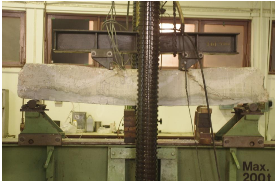
รูปที่ 5-62 การวิบัติของคาน B120WF
