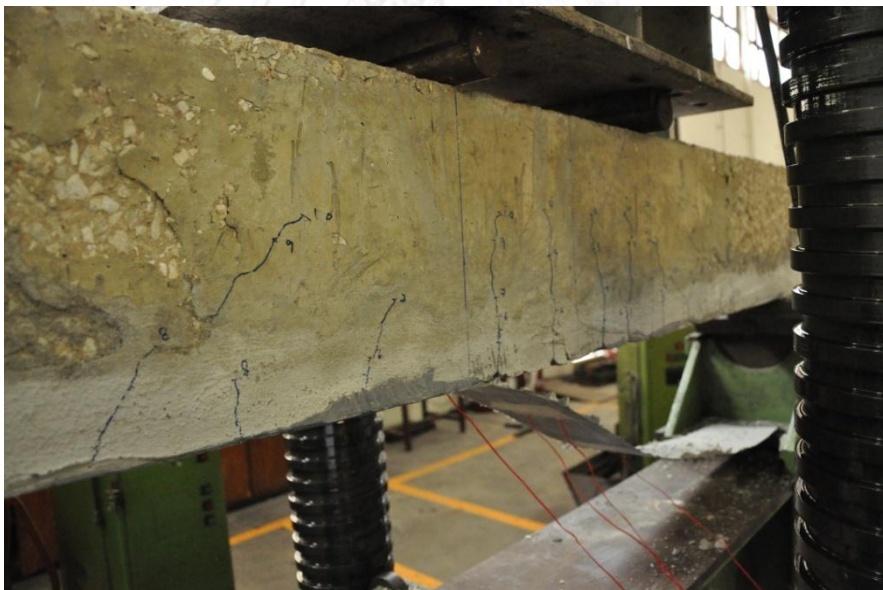
รูปที่ 5-87 การวิบัติของคาน BB120F
