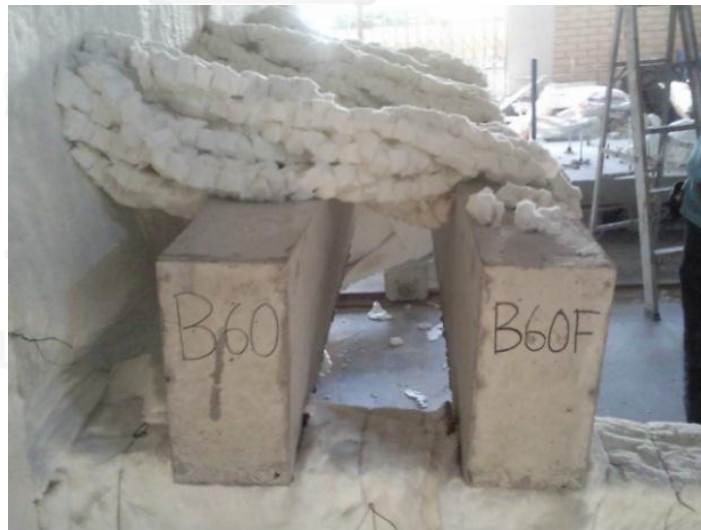
รูปที่ 4-7 การทดสอบเผาไฟแกนคอนกรีตเสริมเหล็กที่ระดับความรุนแรงของไฟ ระยะเวลา 60 นาที
