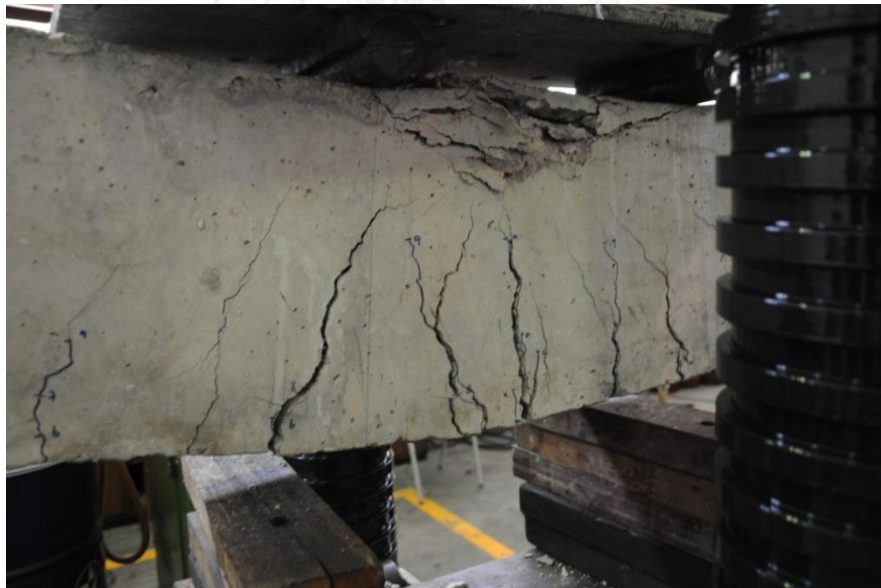
รูปที่ 5-81 การวิบัติของคาน BB90
