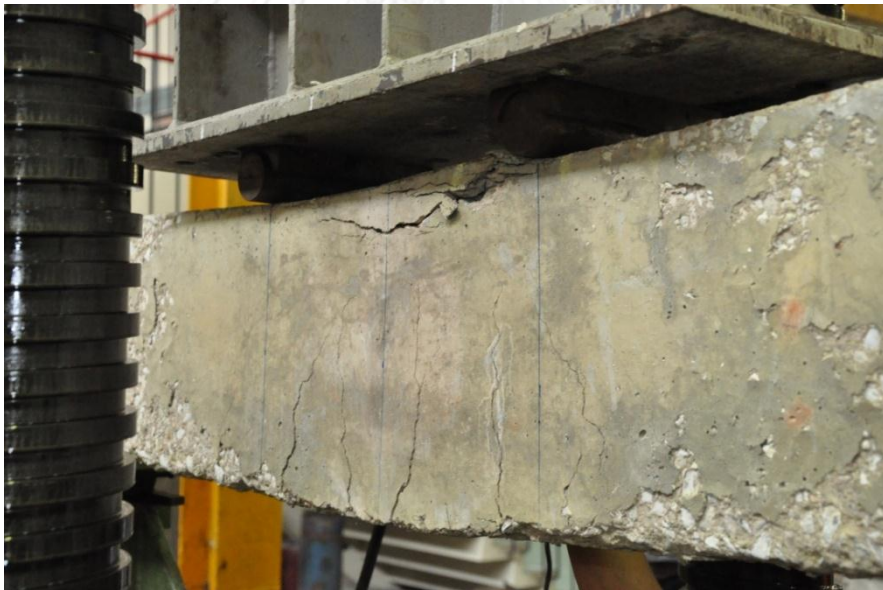
รูปที่ 85 การวิบัติของคาน BB120
