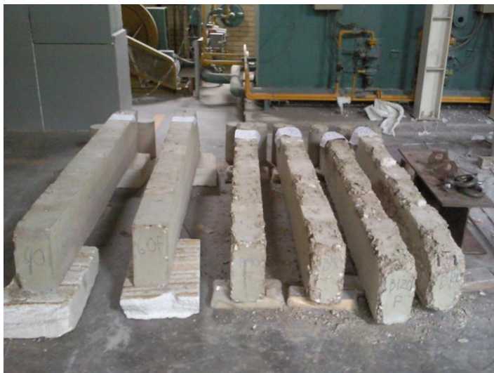
รูปที่ 4-8 ความเสียหายของคานคอนกรีตเสริมเหล็กจากการเผาไฟที่ระดับความรุนแรงของไฟต่างๆ
