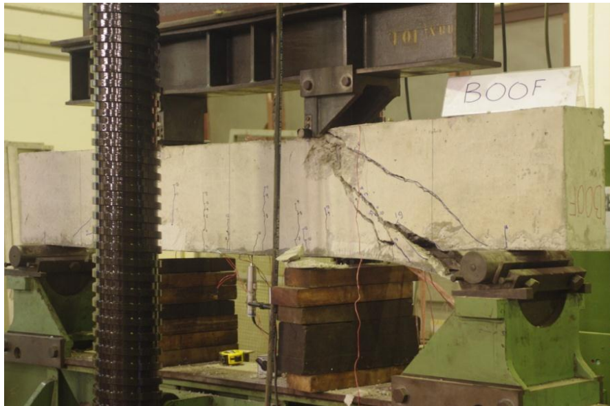
รูปที่ 5-46 การวิบัติของคาน BOOF
