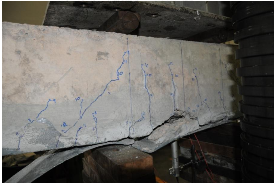
รูปที่ 5-83 การวิบัติของคาน BB90F
