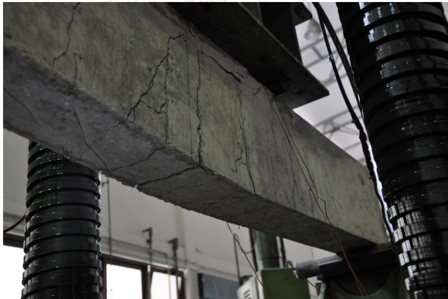
รูปที่ 5-79 การวิบัติของคาน BB00
