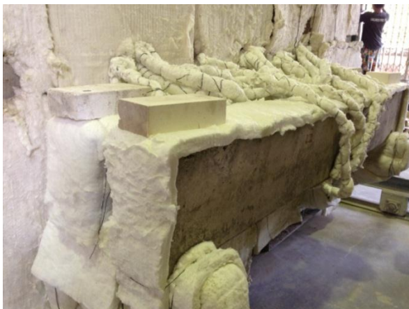
รูปที่ 4-17 ทดสอบเผาไฟคานคอนกรีตเสริมเหล็กที่ระดับความรุนแรงของไฟ ระยะเวลา 90 นาที
