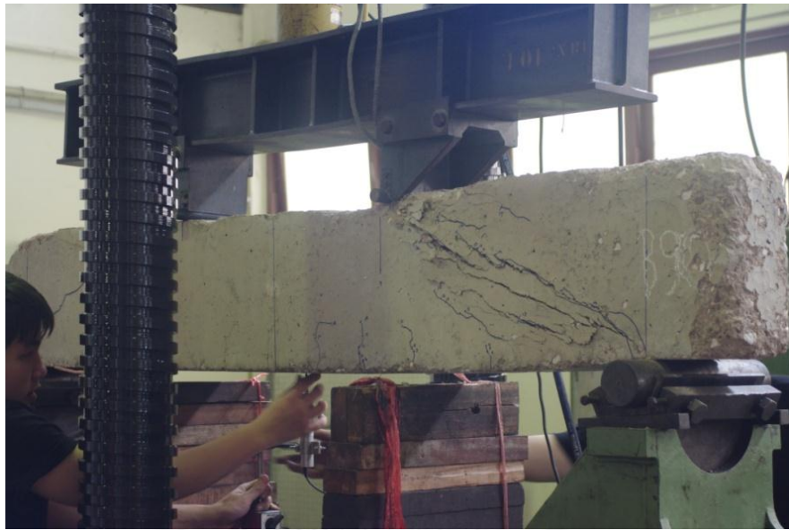
รูปที่ 5-52 การวิบัติของคาน B90
