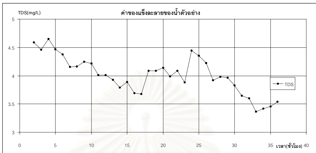
ภาพที่ 4.35 ค่าของแข็งละลายทั้งหมดของน้ำตัวอย่างที่ไหลออกจากถังดูดตีดผิวแบบคอลัมน์ที่ระดับความลึก 180 เซนติเมตร ในช่วงเวลาต่างๆ
