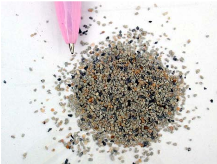
รูปที่ 4.1 ลักษณะทั่วไปของเศษคอนกรีตที่นำมาใช้ในการทดลอง
