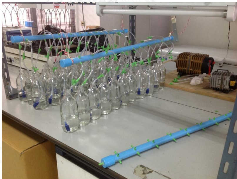
รูปที่ 3.11 อุปกรณ์ในการเพาะเลี้ยงสาหร่าย
