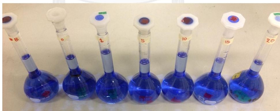
รูปที่ 3.13 การวิเคราะห์ความเข้มข้นโอโซนด้วยการใช้สารละลายอินดิโก
