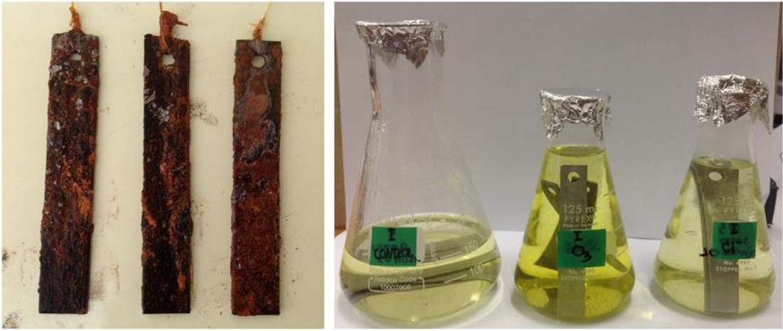
รูปที่ จ.1 ชิ้นงานหลังการทดสอบและการล้างด้วยวิธีเคมี
