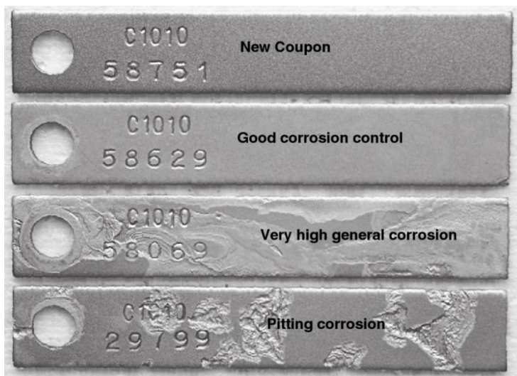
รูปที่ 2.18 การเปรียบเทียบการกัดกร่อนแบบต่างๆ โดยการใช้คูปอง (Coupon) ที่มา: (M Seneviratne, 2006)
