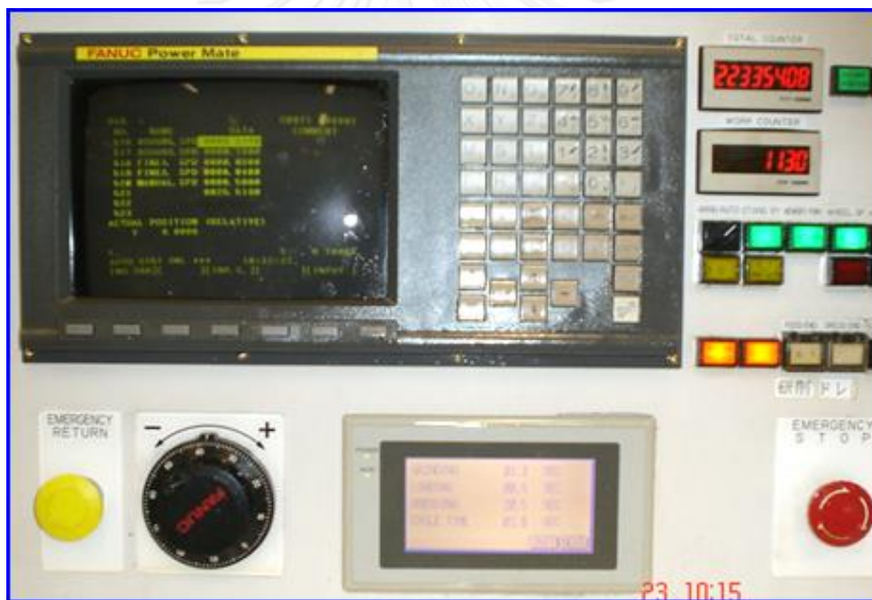
รูปที่ 5. 4 เครื่องควบคุม สำหรับปรับพารามิเตอร์
