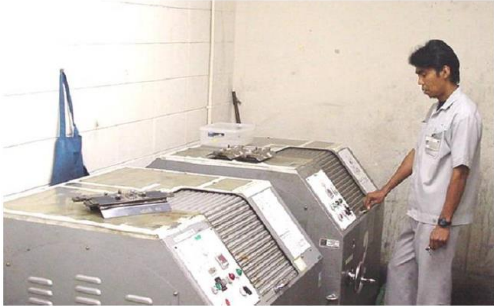
รูปที่ 3. 3 กระบวนการลบคมชิ้นงาน (Barrel Process)
