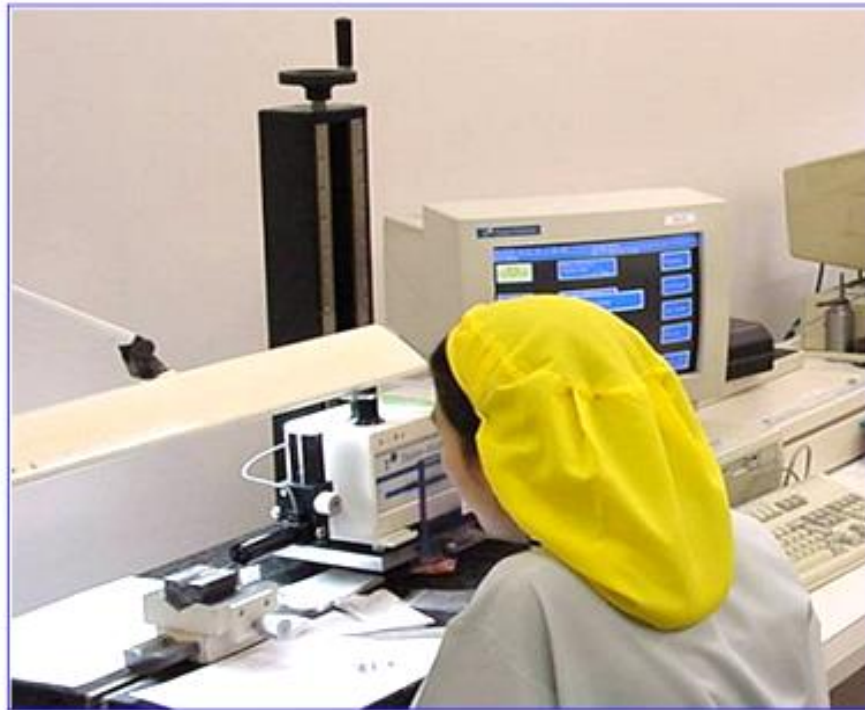
รูปที่ 5. 7 การตรวจสอบค่าความหยาบของชิ้นงาน
