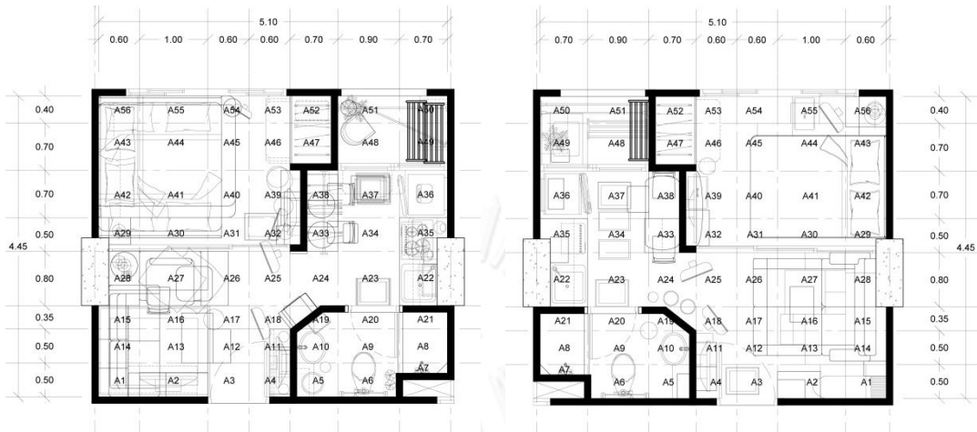
ภาพ 5. 5 แสดงการวิเคราะห์ตำแหน่งเฟอร์นิเจอร์ และอุปกรณ์ภายในห้องชุดแปลน C
