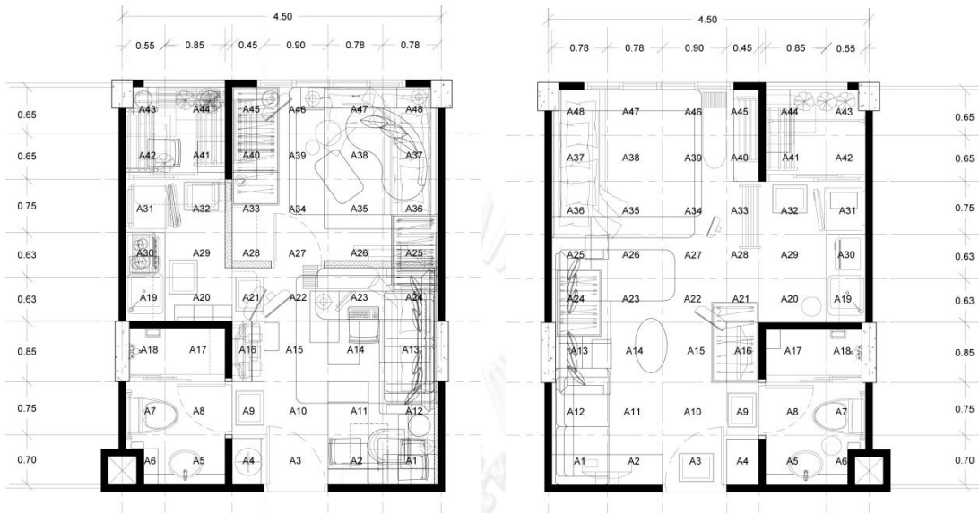
ภาพ 5.3 แสดงการวิเคราะห์ตำแหน่งเฟอร์นิเจอร์ และอุปกรณ์ภายในห้องชุดแปลน B
