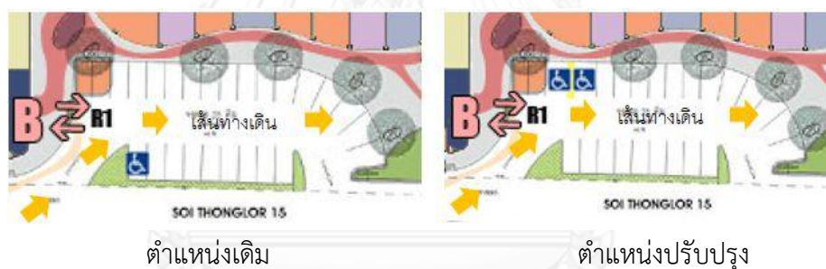
ภาพที่ 5.24 แสดงแนวทางการปรับปรุงตำแหน่งที่จอดรถคนพิการโครงการ J Avenue
