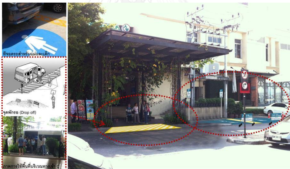
ภาพที่ 5.32 แสดงแนวทางการปรับปรุงที่จอดรถสำหรับทุกคนและจุดพักรถบริเวณทางเข้า C โครงการ The Crystal
