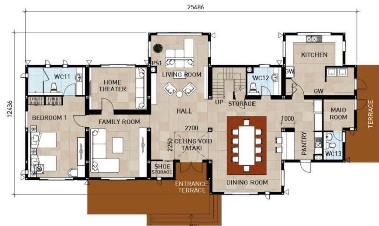
รูปที่ 3.8 แสดงแบบพื้นชั้นล่าง แบบบ้านมาตรฐาน C
