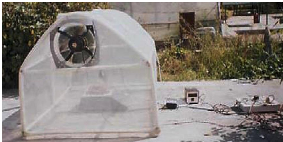
ภาพที่ 6- 3 Greenhouse drying แบบ active mode [22]
