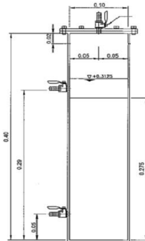
ภาพที่ 3- 3 รายละเอียดด้านข้างของถังปฏิกรณ์แบบแผ่นกั้นไร้ออกซิเจน (ตัวเลขแสดงในหน่วยเมตร)
