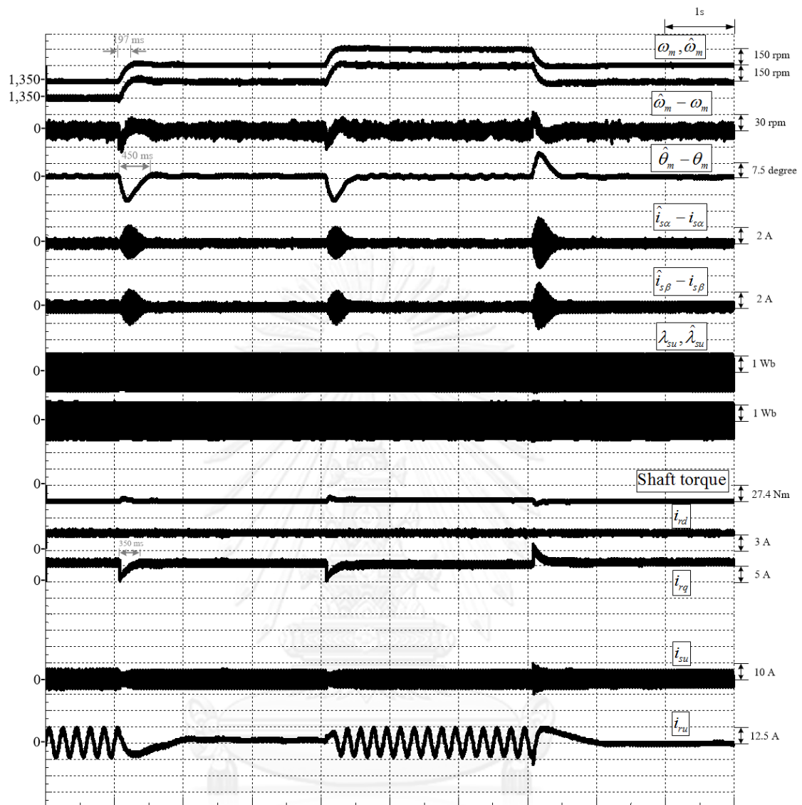
รูปที่ 5.14 ผลการทดลองของระบบที่การเปลี่ยนแปลงความเร็วแบบขั้น ย่านเครื่องกำเนิดไฟฟ้า และกระแสกระตุ้นสร้างฟลักซ์ทางด้านโรเตอร์ 3 A
