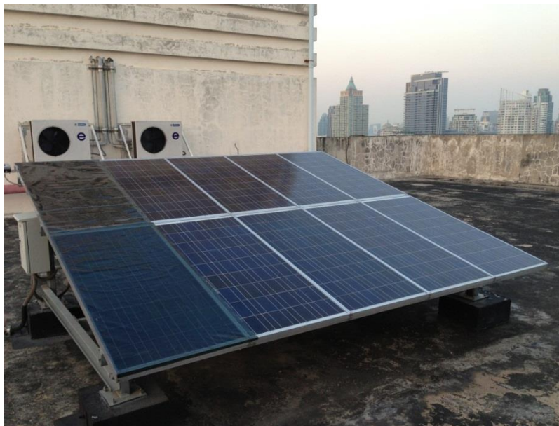
ภาพที่ 8.19 ระบบทดสอบผลกระทบการบังแสงแดดต่อเซลล์แสงอาทิตย์
