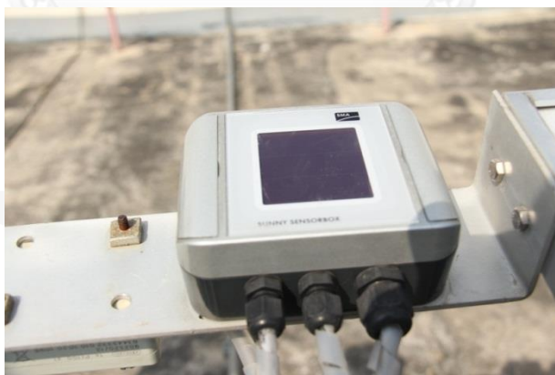
ภาพที่ 7.4 อุปกรณ์วัดความเข้มแสง รุ่น Sunny SENSORBOX
