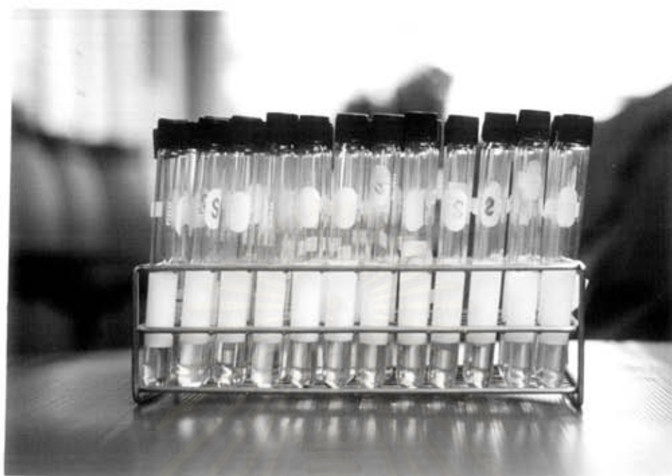
รูปที่ 2.3 แสดงลักษณะอิมัลชันที่เกิดจากการผสมของน้ำเลี้ยงเชื้อกับน้ำมันก๊าด
