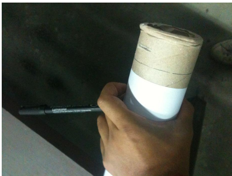
ภาพที่ 3.10 ก่อนทำการตัดควรวาดเส้นรอบวงเพื่อให้การตัดมีความเที่ยงตรง
