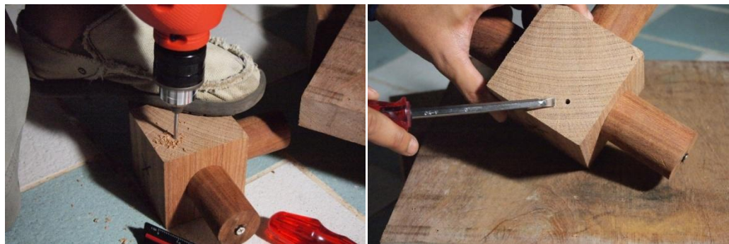
ภาพที่ 5.22 เจาะรูที่ได้ให้ลึกพอประมาณ
