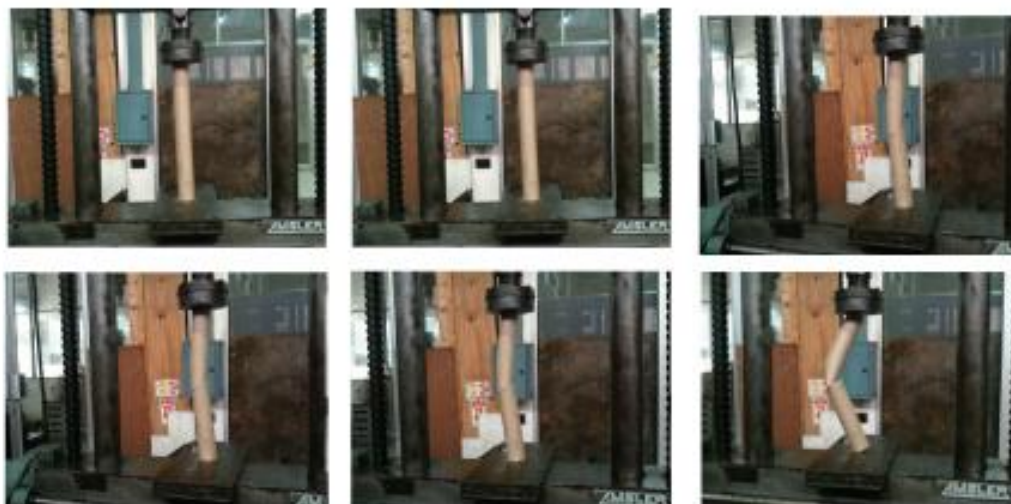
ภาพที่ 4.1 การทดลองแรงอัดกับท่อกระดาษ
