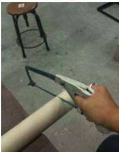
ภาพที่ 3.11 ใช้เลื่อยมือเป็นเครื่องมือในการตัด
