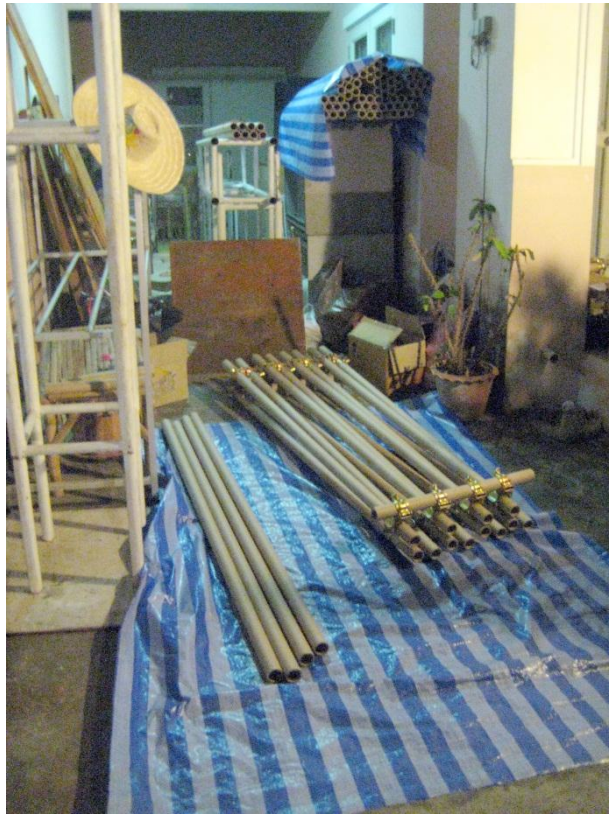
ภาพที่ 4 ทดสอบการพับเก็บของชุดท่อกระดาษว่าสามารถพับเก็บเข้าด้วยกันได้แนบสนิท
