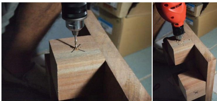
ภาพที่ 5.27 เจาะรูที่บล็อกเชื่อมต่อกับท่อกระดาษ
