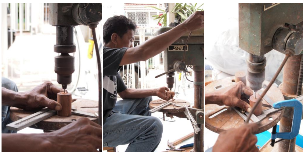
ภาพที่ 5.12 การปฏิบัติขณะเจาะแผ่นไม้ด้วยสว่านแทน
