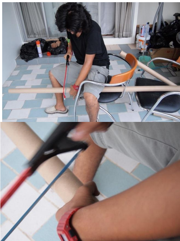
ภาพที่ 5.40 ตัดท่อกระดาษตามความยาวที่กำหนดไว้เพื่อนะไปติดตั้งกับส่วนข้อต่อไม้
