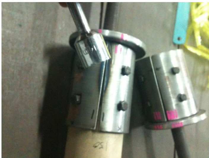
ภาพที่ 3.15 ตัวจับปลายท่อเมื่อแล้วเสร็จ
