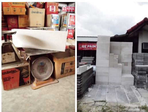
ภาพที่ 5.49 อิฐมวลเบาที่จะใช้ทดสอบโครงสร้าง
