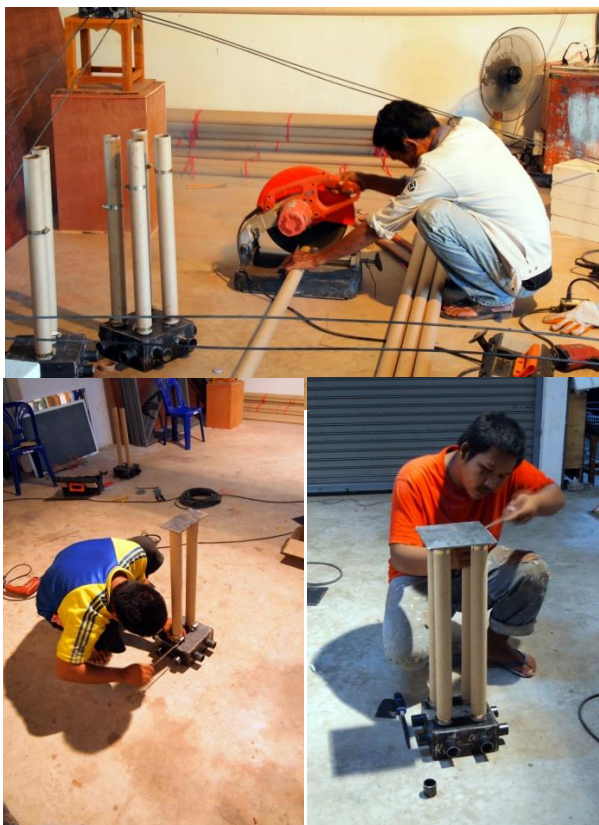
ภาพที่ 5.63 การตัดท่อกระดาษและประกอบเป็นท่อตั้ง
