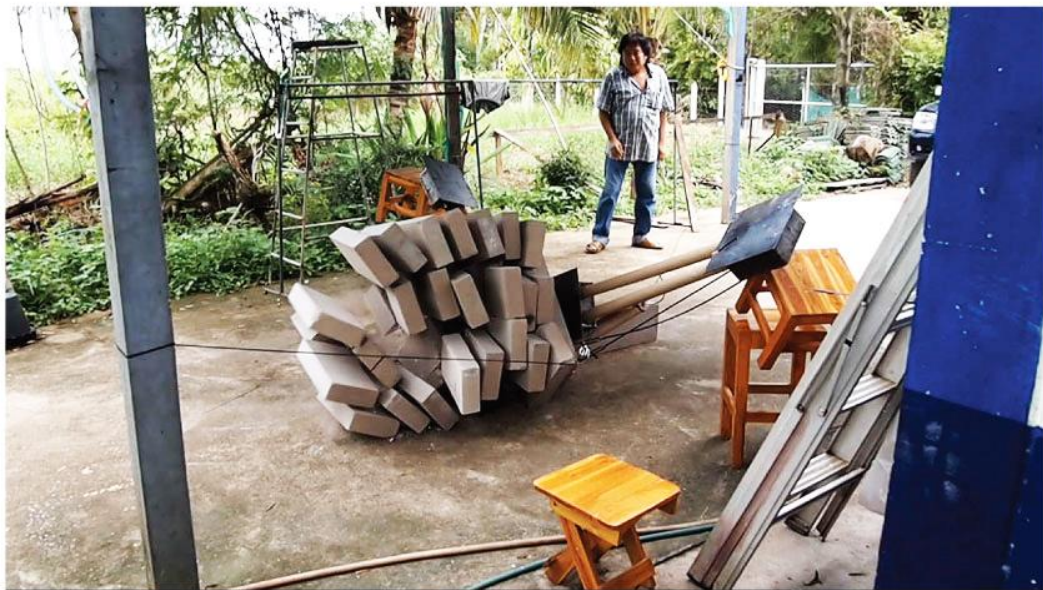
ภาพที่ 5.58 การทดลองคานขนาด 240 เซนติเมตร
