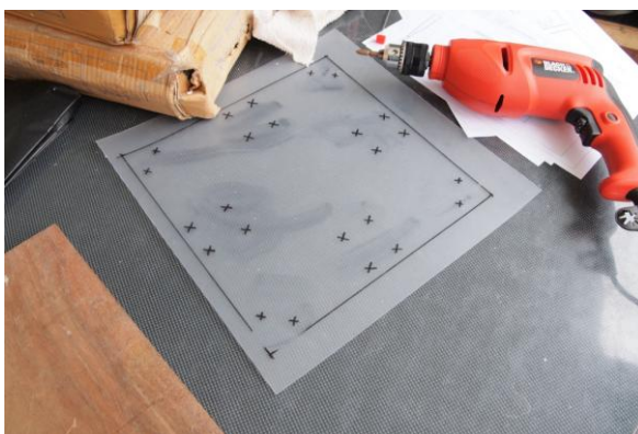
ภาพที่ 5.8 แม่แบบในการเจาะรูบนไม้ใช้แผ่นพลาสติกเพื่อความแม่นยำ
