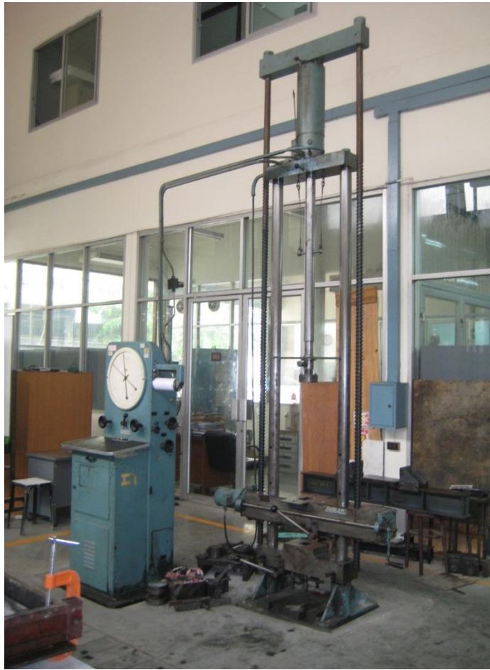
ภาพที่ 3.21 เครื่องทดสอบรูน Universal Testing Machine Amsler 20T ที่ใช้ในการทดสอบ
