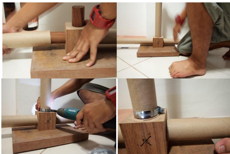
ภาพที่ 5.41 การติดตั้งใช้การสวมท่อกระดาษลงไปในเดือยไม้
