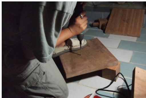
ภาพที่ 5.18 ไขสกรูนำลงไปก่อน
