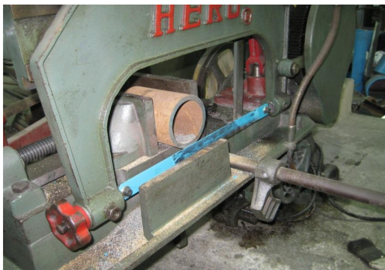
ภาพที่ 3.14 เครื่องตัดเหล็กสำหรับขั้นตอนในการทำตัวจับปลายท่อ
