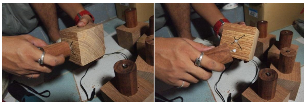
ภาพที่ 5.34 บล็อกไม้ส่วนรับท่อคานโดยใช้ขั้นตอนเดียวกับการประกอบเดียวที่แสดงไว้ก่อนหน้านี้
