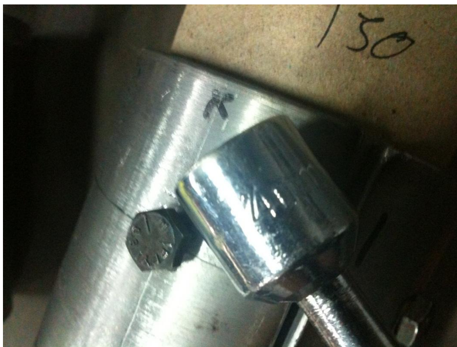
ภาพที่ 3.16 ใช้ตะปูเกลียวหกเหลี่ยมเป็นตัวยึด
