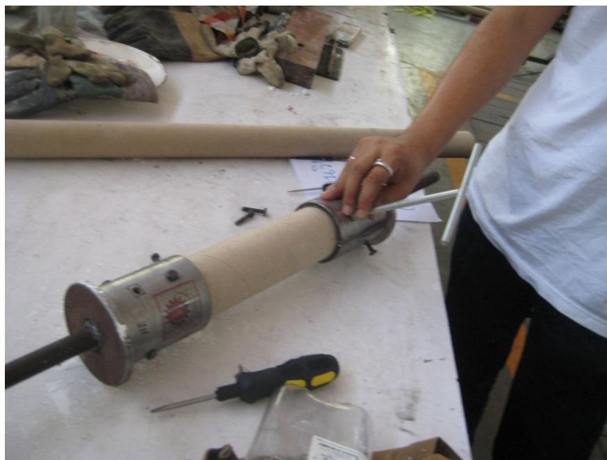
ภาพที่ 3.18 รูปร่างเมื่อประกอบแกนเหล็กตัวจับเข้ากับปลายท่อกระดาษ
