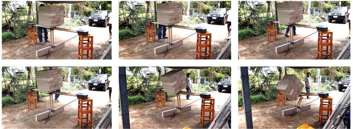
ภาพที่ 5.58 การทดลองคานขนาด 240 เซนติเมตร
