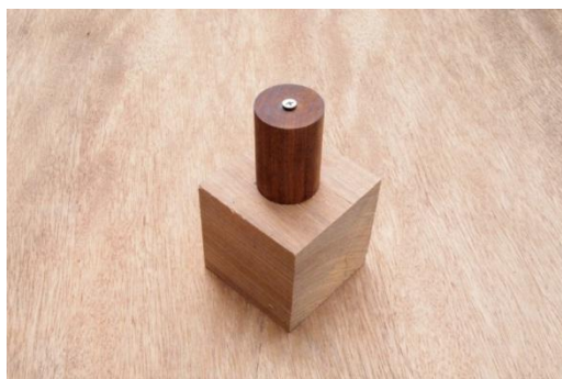
ภาพที่ 5.35 ชิ้นส่วนข้อต่อไม้รับเสาท่อคาน
