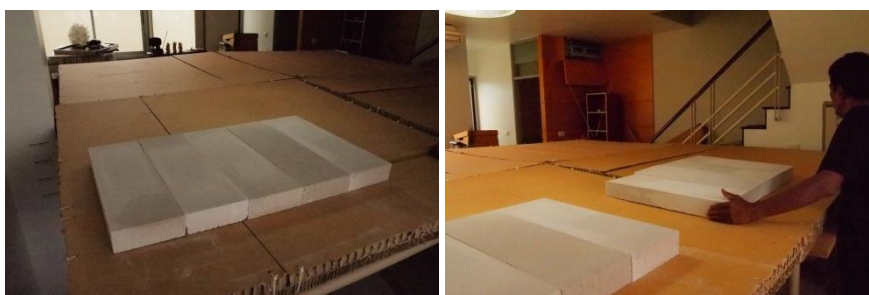
ภาพที่ 5.50 ระหว่างการทดสอบค่อยๆ เြียงอิฐเพื่อเฉลี่ยการรับน้ำหนักของโครงสร้าง
