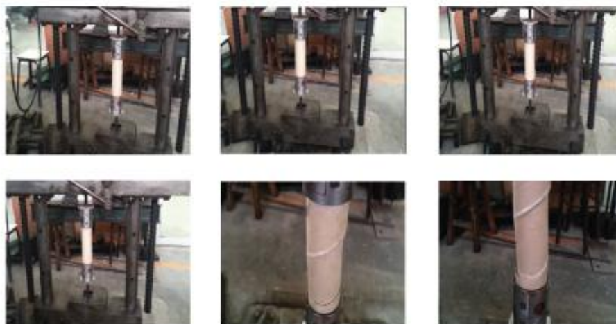
ภาพที่ 4.5 การทดลองแรงดึงกับท่อกระดาษ
