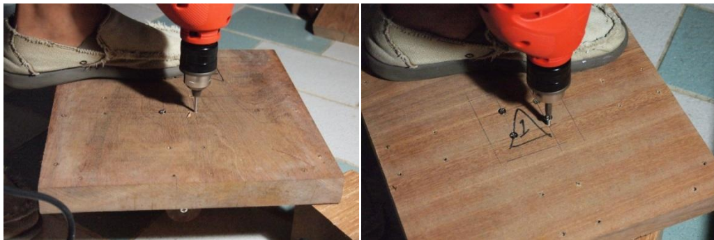
ภาพที่ 5.25 ทำการเจาะรูที่เหลืออีกสามรูพร้อมยึดสกรูให้เรียบร้อย
