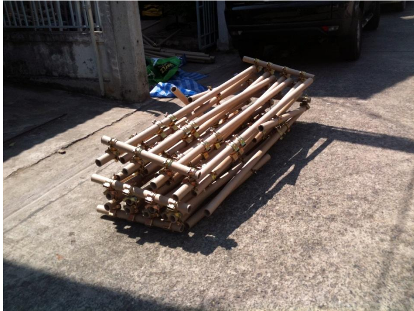
ภาพที่ 10 ชุ่มประตุมือพับเก็บเตรียมขนส่ง
