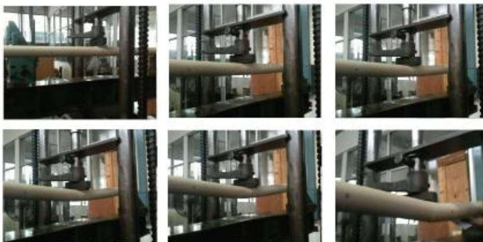
ภาพที่ 4.3 การทดลองแรงดัดกับท่อกระดาษ
