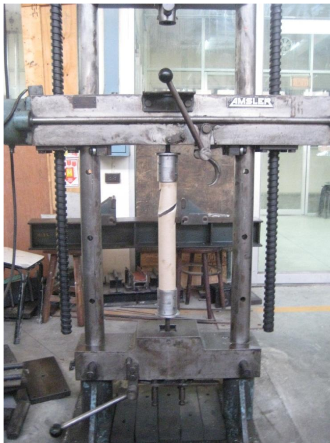
ภาพที่ 3.19 เครื่องทดสอบรูน Universal Testing Machine Amsler 20T ขณะทำการทดสอบ
