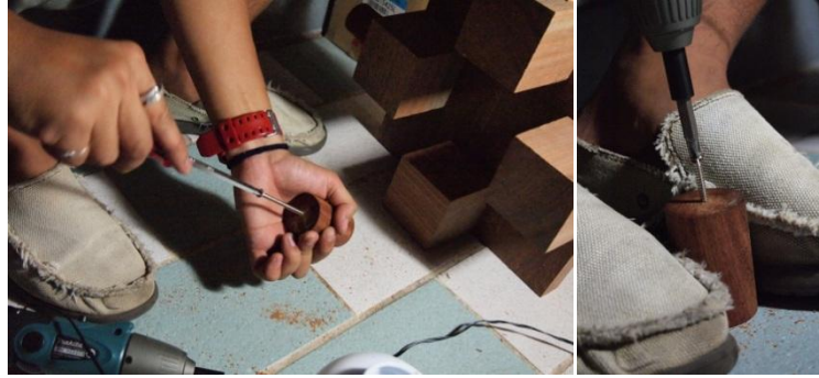
ภาพที่ 5.29 นำสกรูยึดเข้ากับเดือยโดยไขลงไปจนสุด
