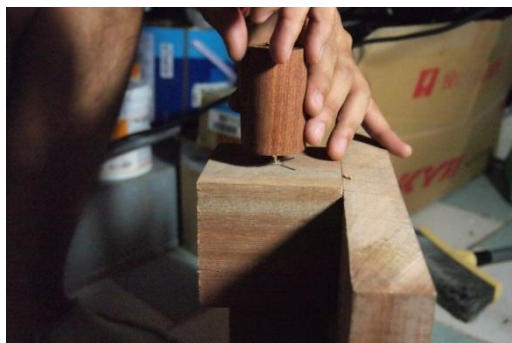
ภาพที่ 5.32 ติดตั้งเดือยเข้ากับบล็อกไม้โดยใช้มือหมุนเข้าไป
