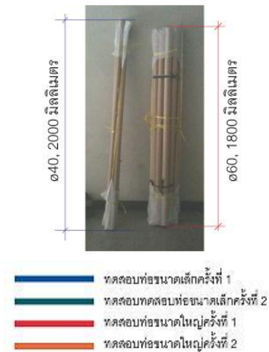
ภาพที่ 3.22 ท่อกระดาษที่ใช้ในการทดสอบ
