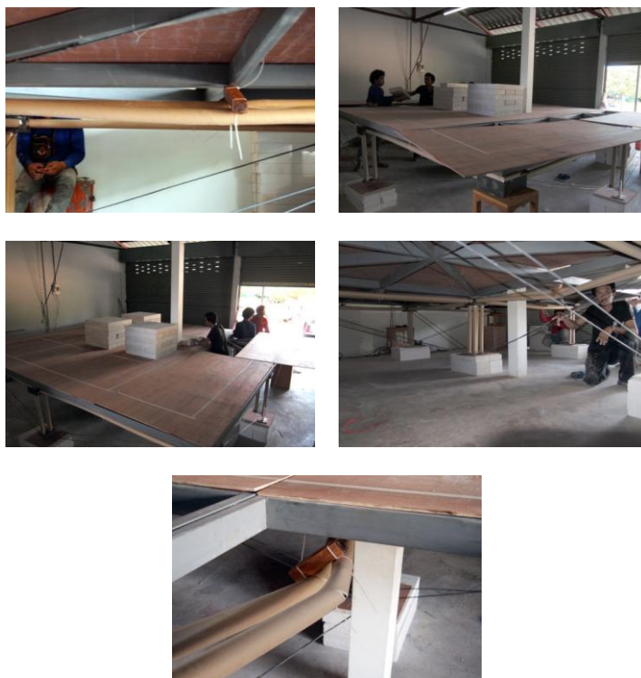
ภาพที่ 5.72 ผลลัพธ์จากการรับน้ำหนักของโครงสร้างท่อกระดาษ โครงสร้างของคานบริเวณกึ่งกลางได้เกิดการพับตัวลงมาน้ำหนัก เป็นอันจบการทดลอง
