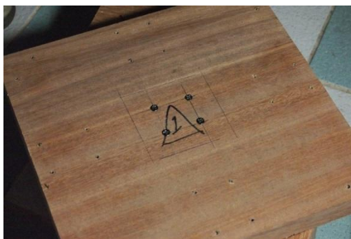
ภาพที่ 5.26 สภาพเมื่อเสร็จเรียบร้อยยึดสกรูทั้งสี่แล้ว
