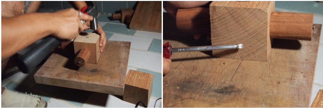
ภาพที่ 5.21 ตอกลงไปด้วยความแรงพอเหมาะจะได้รอยจุดที่ต้องการเจาะ
