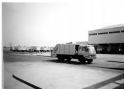
(4) รถกำจัดมูลฝอยประเภทชนิดอัด ภายในสถานีขนถ่ายมูลฝอย
