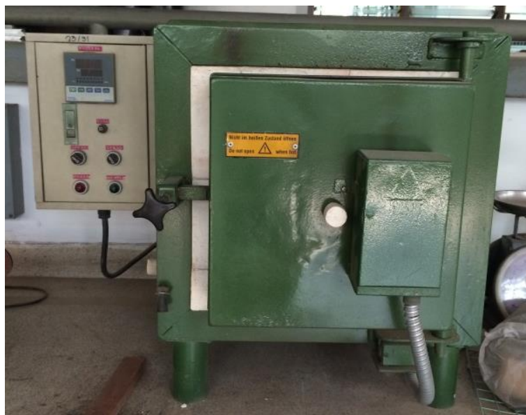
เตาไฟฟ้า (Electronic furnace) - Nabertherm ประเทศเยอรมนี อุณหภูมิสูงสุดในการทำงาน ที่ 1300 องศาเซลเซียส
