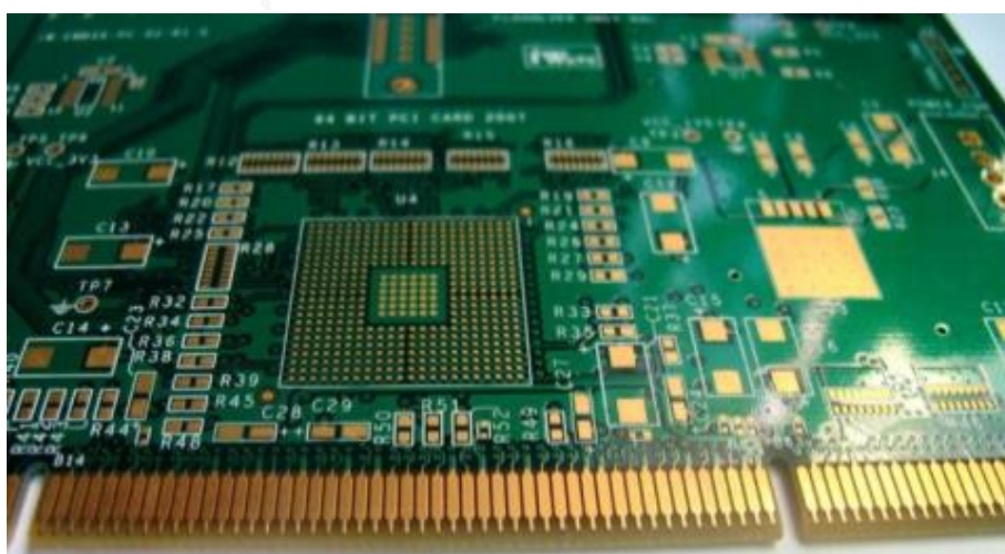
รูปที่ 2.8 แผงวงจรอิเล็กทรอนิกส์แบบ Multi Layered Board
