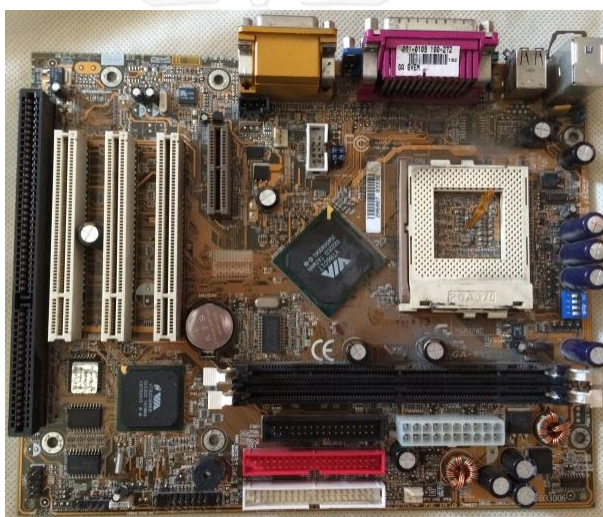
แผงวงจรอิเล็กทรอนิกส์ (Printed Circuit Boards : PCB) แบบ Multi Layered Board ยี่ห้อ : ASUS
