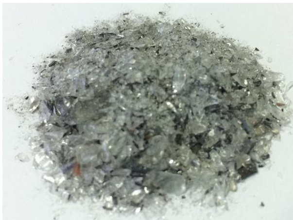
แก้วจากจอซีอาร์ที (CRT glass) จาก โทรทัศน์สี Samsung ขนาด 14 นิ้ว
