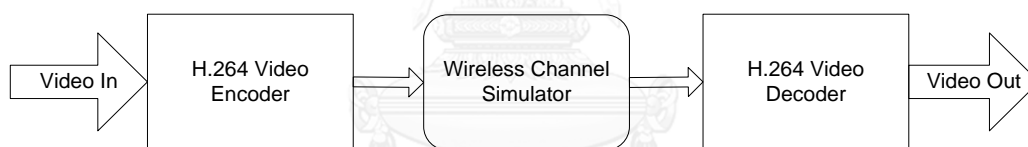
รูปที่ 2.12 แผนภาพบล็อกของระบบการจำลองการสื่อสารวิดีโอ
