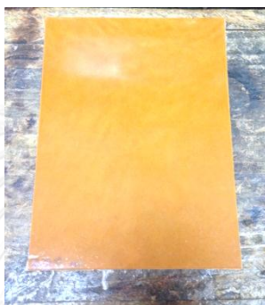
รูปที่ 3.4 ชิ้นทดสอบที่ขึ้นรูปด้วยกระบวนการอัดแบบ
