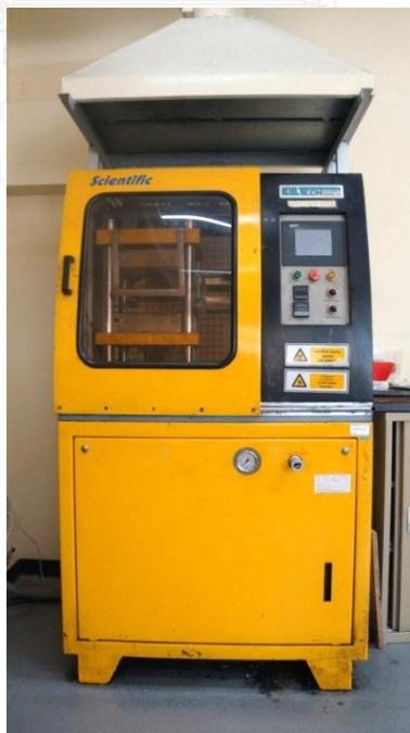
รูปที่ 3.5 เครื่องอัดแบบร้อน LP S-20
