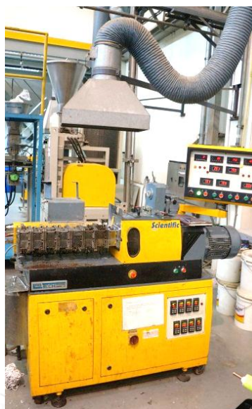
รูปที่ 3.2 เครื่องอัลตราซาวด์แบบเกลียวคู่รุ่น Scientific LW-100
