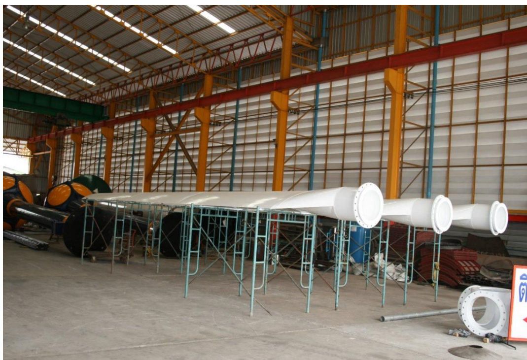
ภาพที่ 4.30 ใบพัดจริงที่ใช้ในงานวิจัย ความยาว 9.81 เมตร
