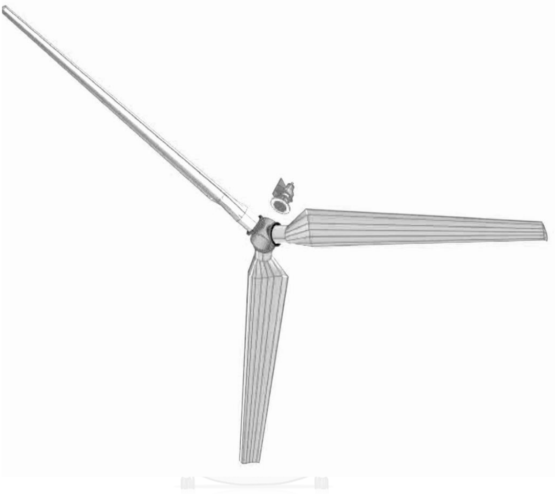
ภาพที่ 4.8 แบบใบพัดที่ประกอบเข้ากับจุดปรับมุมใบพัด แบบ 3 ใบพัด
