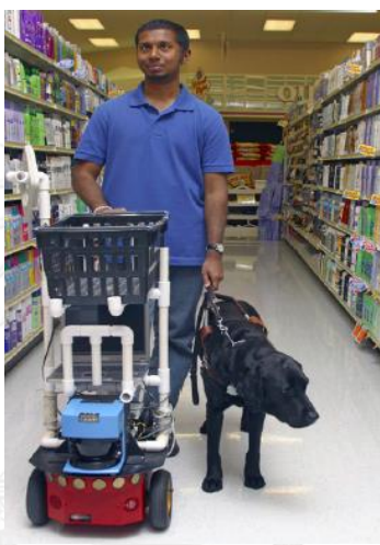
รูปที่ 7 Robocart หุ่นยนต์ผู้ช่วยสำหรับซื้อสินค้าสำหรับคนตาบอด ที่มา : (Kulyukin and Kutiyawala, 2010)
