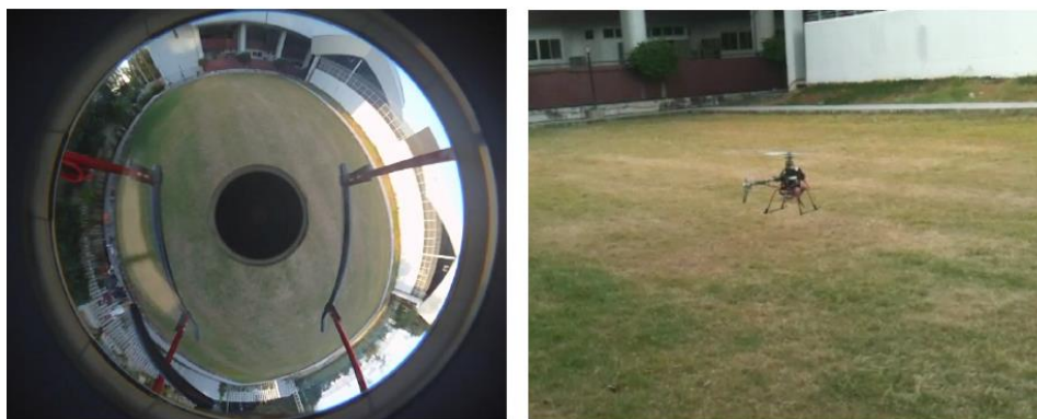
รูปที่ 1.1 ตัวอย่างภาพที่ได้จากกล้องออมินิที่ติดตั้งอยู่บนเฮลิคอปเตอร์บังคับวิทยุ
