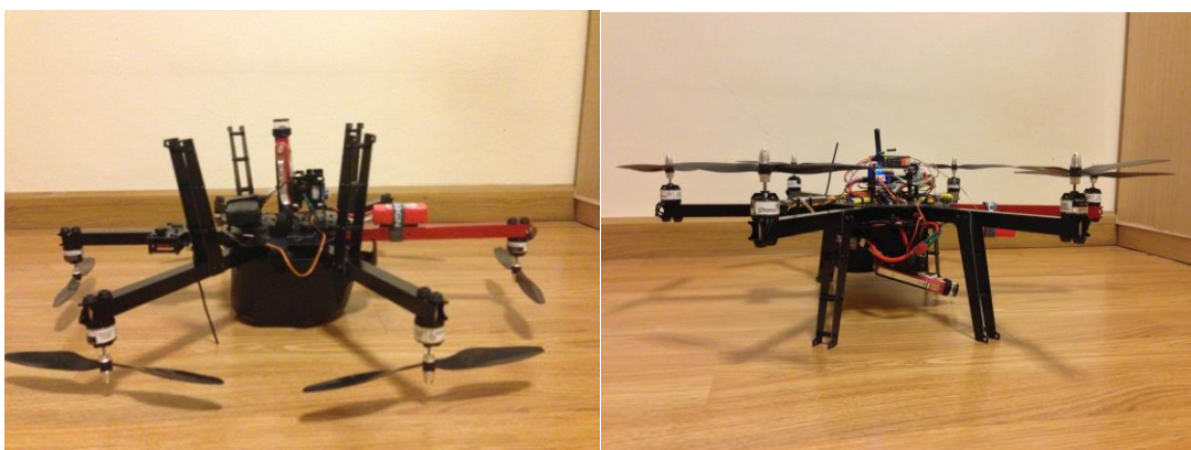
รูปที่ 5.7 ภาพการวางตัวของกล้องเปรียบเทียบระหว่างขณะบิน (ซ้าย) และขณะอยู่บนพื้น
