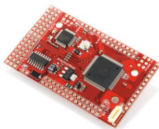
รูปที่ 5.3 บอร์ดประมวลผลหลัก Ardupilot Mega
