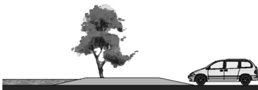
ภาพที่ 2.6 การยกขั้วมทางเข้าโครงการเพื่อป้องกันน้ำเข้าโครงการ
