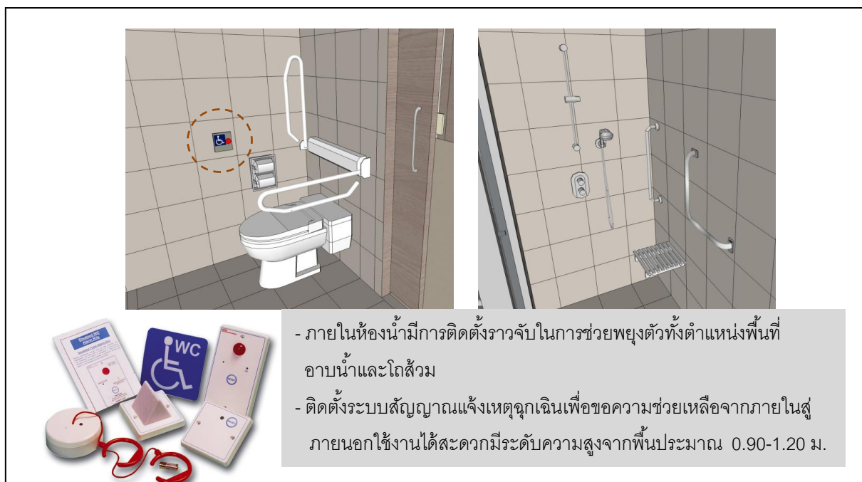
ภาพที่ 6.5 แสดงข้อเสนอแนะแนวทางการปรับปรุงห้องน้ำภายใน ลำดับ 2 การปรับปรุงเพื่อความสะดวกต่อการใช้งานของพื้นที่ต่างๆมากยิ่งขึ้น
