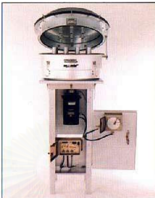
รูปที่ 3.3 อุปกรณ์ตรวจวัดฝุ่นขนาดเล็กกว่า 10 ไมครอน ชนิดไฮโวลูม ที่มา : http://www.sci.tu.ac.th/std-web/air-noise/Sampling.HTML
