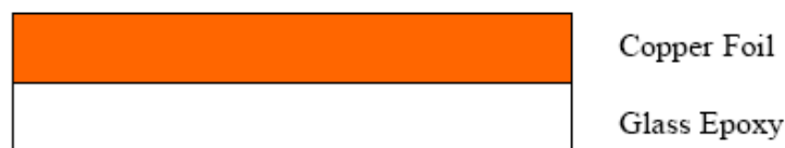
รูปที่ 2-15 โครงสร้าง RPC (Rigid Printed Circuit Board)
