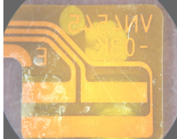
รูปที่ 1-10 ตัวอย่างลักษณะของข้อบกพร่องประเภทฟองอากาศ (Bubble) ระหว่าง CL และ Stiffener
