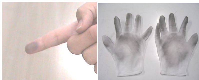
รูปที่ 6-3 แสดงคราบและเศษผงจากการขัดแผ่นเหล็กด้วยกระดาษทราย
