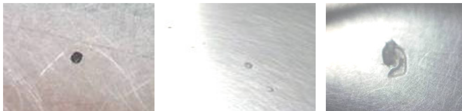
รูปที่ 6-1 แสดงตัวอย่างสิ่งสกปรกที่ติดบนแผ่นเหล็กก่อนทำการขัดแผ่นเหล็ก
