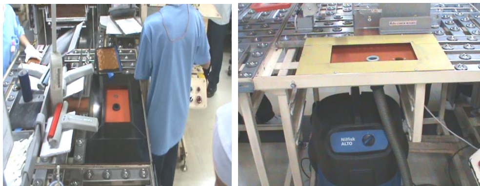
รูปที่ 6-8 ตัวอย่างของชุด Vacuum แบบง่ายในการช่วยจับยึดชิ้นงาน
