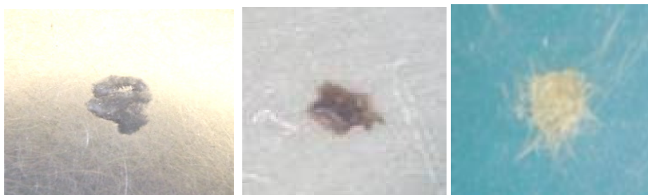
ดั่งรูปที่ 5-3 ตัวอย่างของเศษสิ่งแปลกปลอมที่ติดบนแผ่นเหล็ก
