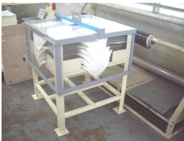
รูปที่ 6-5 วิธีเก็บแผ่นเหล็กหลังการขัด (Stainless Plate) หลังการปรับปรุง
