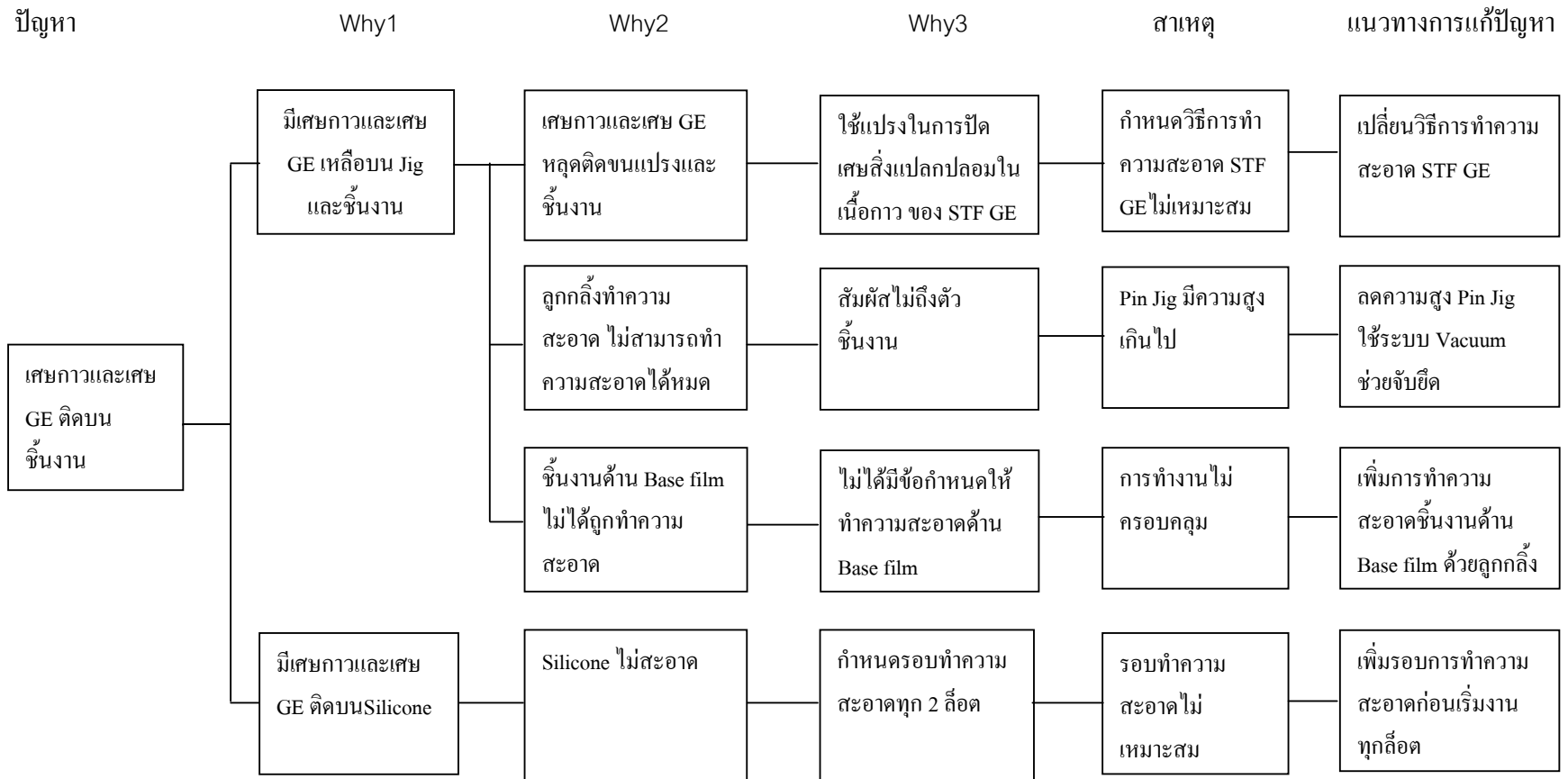
รูปที่ 6-9 แผนภาพการวิเคราะห์ Why-why analysis ในการระดมความคิดเพื่อหาสาเหตุของปัญหาเศษกาวและเศษSTF GE ติดบนชิ้นงาน
