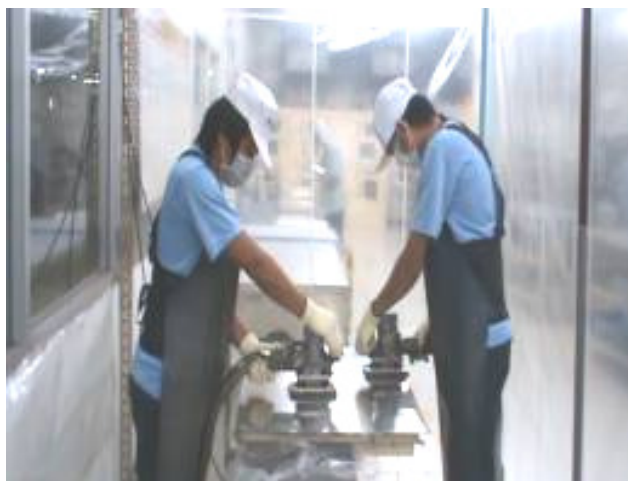
ผังรูปที่ 5-2 การขัดแผ่นเหล็ก (Stainless Plate) ด้วยกระดาษทราย
