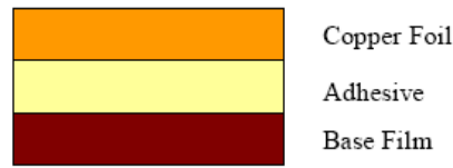
รูปที่ 2-13 โครงสร้าง CCL (Copper Clad Laminates) ชนิดที่มีทองแดงด้านเดียว
