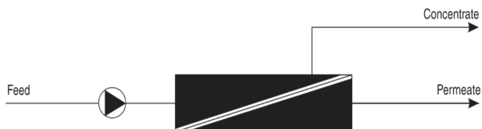
ภาพที่ 2.14 การเดินระบบแบบต่อเนื่อง (Dow Chemical Company, 2012)
