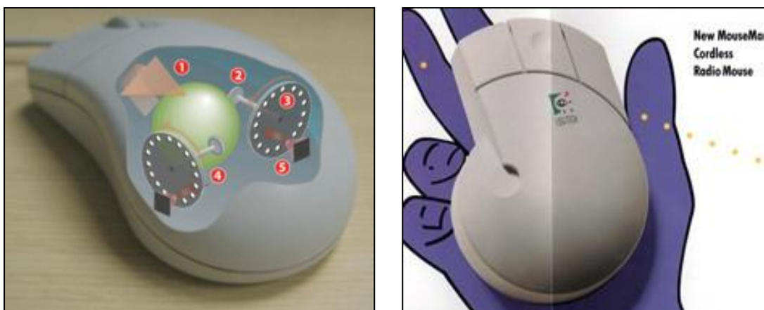
รูปที่ 2.5 ลักษณะการทำงานของ Ball Mouse (ซ้าย) เมาส์ไร้สายตัวแรกโดย Logitech (ขวา) [4]
