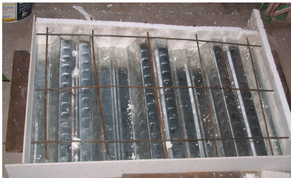
ภาพที่ 4.32 แสดงการทดลองนำแผ่นเหล็กกรีดลอนเคลือบ Galvanized หนา 0.08 มิลลิเมตร มาผูกเหล็ก ทำไม้แบบเพื่อเทคอนกรีต
