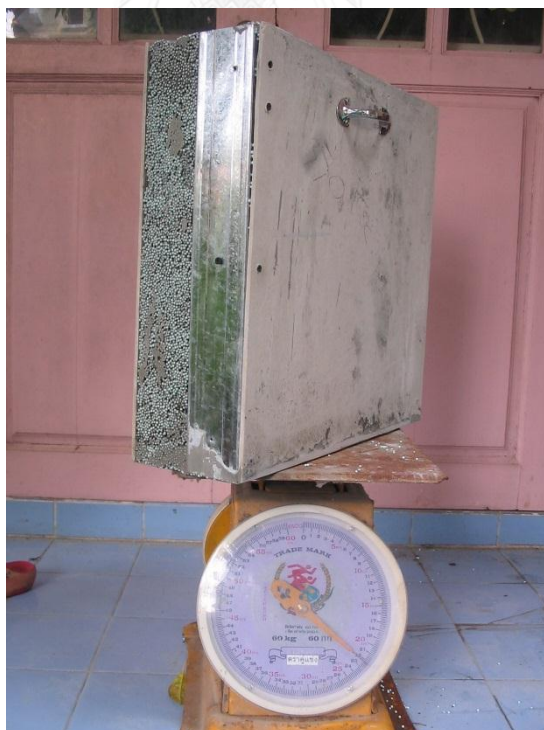
ภาพที่ 4.23 แสดงการทดลองทำผนังประกอบไฟเบอร์บอร์ดภายในกรุโพนมคอนกรีต ( Fiberbord infilwall) ขนาด 50 x 50 x 15 เซนติเมตร ความหนาแน่นที่ 250 ก.ก. ต่อ 1 ล.บ.ม.น้ำหนักรวม
