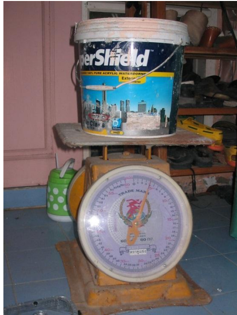
ภาพที่ 4.14 แสดงการชั่งน้ำหนักสัดส่วนของซีเมนต์ (ก.ก.)
