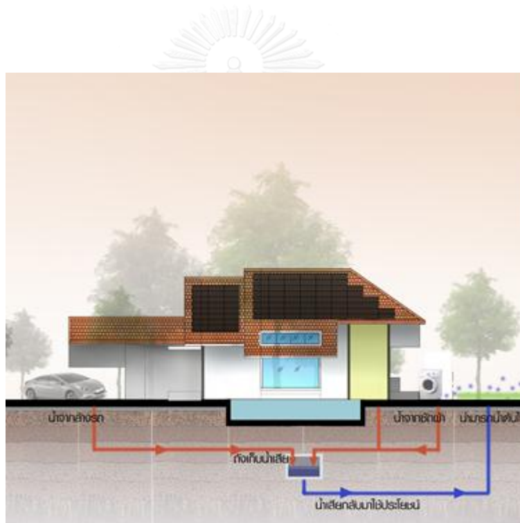
ภาพที่ 2.17 แสดงการหมุนเวียนในการนำน้ำมาใช้อีกครั้งเพื่อให้เกิดประโยชน์สูงสุด เช่น น้ำล้างรถ น้ำซักผ้า น้ำอาบ น้ำล้างมือ ฯลฯ (สุนทร บุญญาธิการ 2545)
