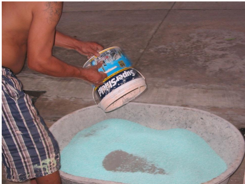
ภาพที่ 4.15 แสดงการผสมด้วยมือเพื่อทำการทดลอง ควรผสมโพนกับซีเมนต์(ต้องเป็นปูนซีเมนต์พอร์ตแลนด์เท่านั้น) ให้เข้ากันก่อนจึงใส่น้ำลงไปผสมภายหลัง
