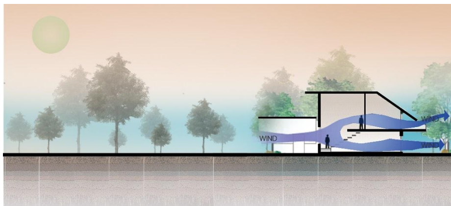
ภาพที่ 4.2 แสดงลมธรรมชาติที่พัดผ่านบ้านประหยัดพลังงานที่สร้างได้เร็วด้วยแรงคน (สุนทร บุญญาธิการ 2545)
