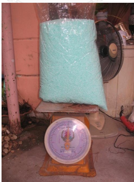
ภาพที่ 4.13 แสดงการชั่งน้ำหนักวัสดุส่วนของเม็ดโพนขนาด 2-4 ม.ม.(ก.ก.)
