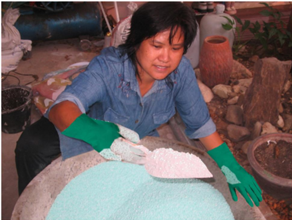
ภาพที่ 4.16 แสดงการผสมโฟมกับซีเมนต์ เมื่อเข้ากันดีแล้วจึงใส่น้ำลงไปตามสัดส่วนที่กำหนด
