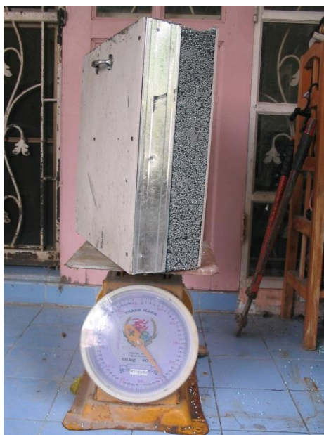
ภาพที่ 4.22 แสดงการทดลองทำผนังประกอบไฟเบอร์บอร์ดภายในกรุโพนมคอนกรีต ( Fiberbord infilwall) ขนาด 50 x 50 x 15 เซนติเมตร ความหนาแน่นที่ 350 ก.ก. ต่อ 1 ล.บ.ม.น้ำหนัก 650 ก.ก.ต่อ 1 ล.บ.ม.น้ำหนักผนังโดยรวมที่ความหนา 15 เซนติเมตร เท่ากับ 96 ก.ก.ต่อ 1 ตารางเมตร
