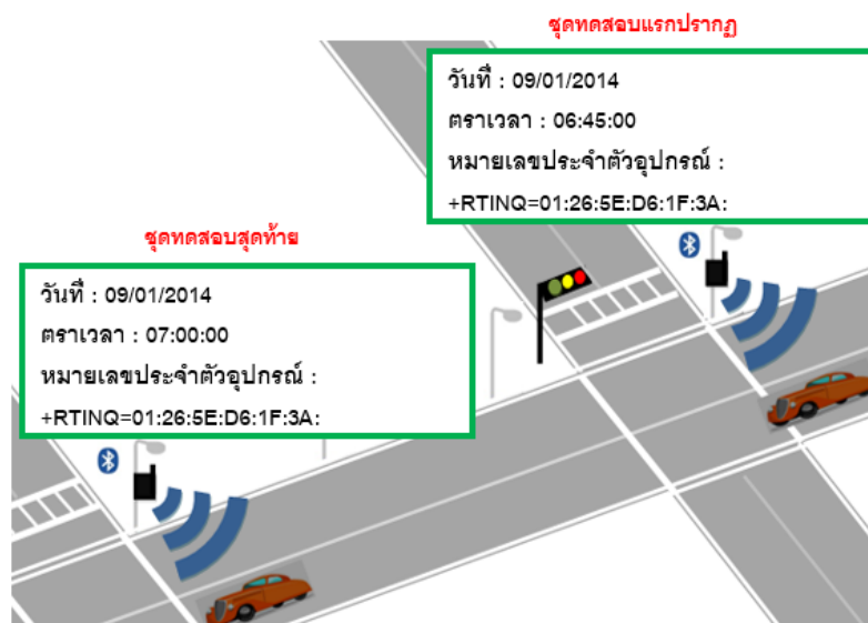
รูปที่ 3.1 : ภาพรวมของระบบตรวจวัดสภาพการจราจรโดยใช้ตัวรับรู้ประเภทบลูทูธ
