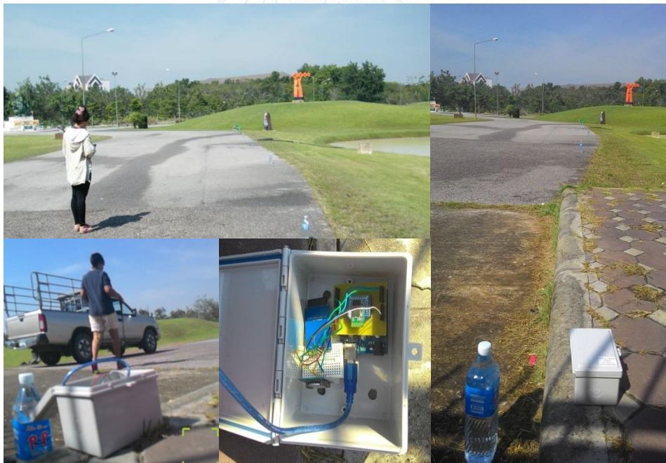
รูปที่ 3.7 : การทดสอบหาระยะตรวจจับไกลสุด ภายในบริเวณมหาวิทยาลัยศิลปากร วิทยาเขตสารสนเทศเพชรบุรี
