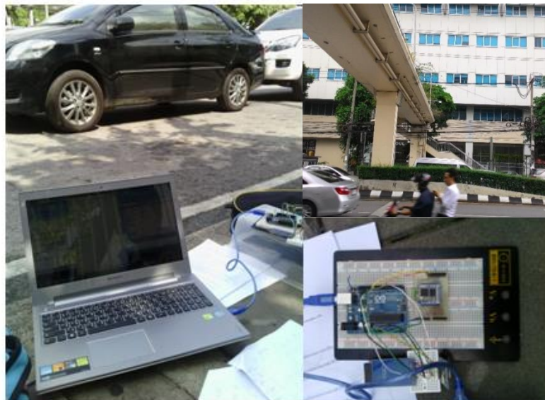
รูปที่ 3.8 : การทดสอบหาความเร็วสูงสุดของอุปกรณ์บลูทูธที่ตัวรับรู้ประเภทบลูทูธสามารถตรวจจับได้บนถนนอังรีดูนังต์ บริเวณจุฬาลงกรณ์มหาวิทยาลัย ในเขตกรุงเทพมหานคร
