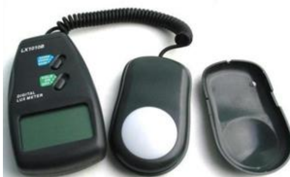
รูปที่ 3.40 อุปกรณ์วัดปริมาณความเข้มแสงสว่าง
