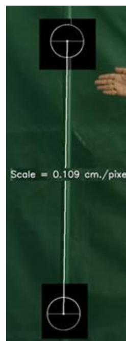
(ค) การหามาตราส่วนอัตโนมัติ ด้วยโปรแกรมวัดส่วนร่างกายบนแท็บเล็ต
