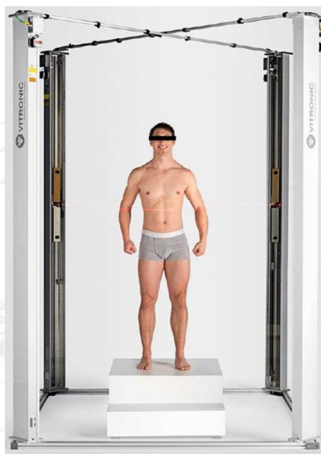
รูปที่ 1.4 การทำงานของเครื่องสแกนเนอร์ 3 มิติ โดยใช้เทคนิคแสงเลเซอร์ ที่มา : (H.A.M. Daanena and F.B. Ter Haara, 2013)
