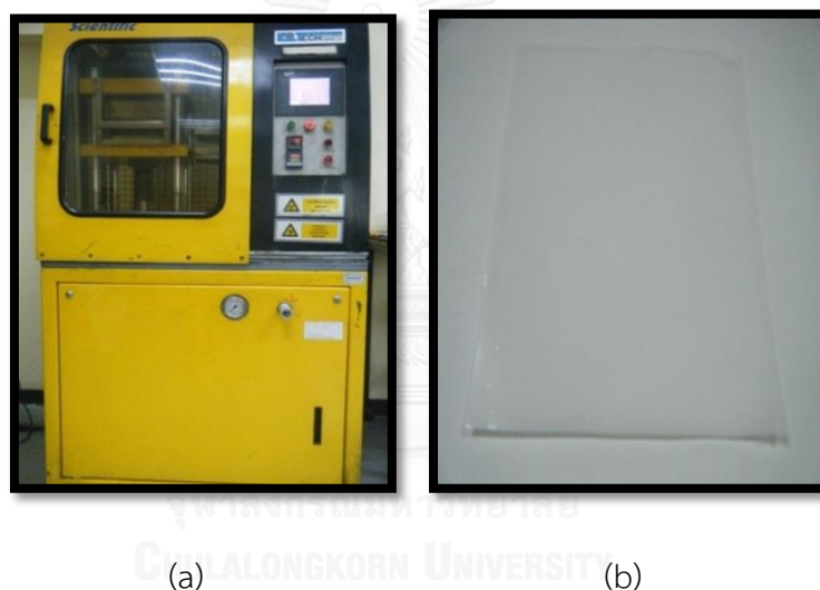
รูปที่ 3. 2 (a) เครื่องมือขึ้นรูป (compression) (b) ตัวอย่างแผ่นพลาสติกที่ขึ้นรูปได้
