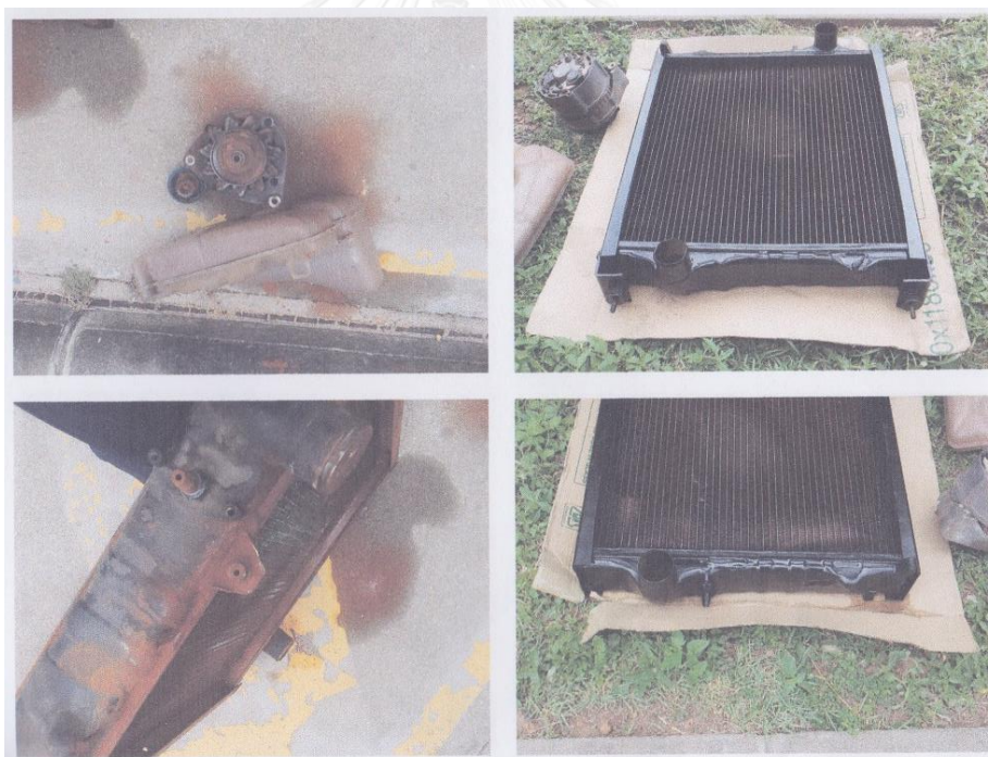
รูปที่ 6.3 หม้อน้ำที่เกิดการเสียหาย
