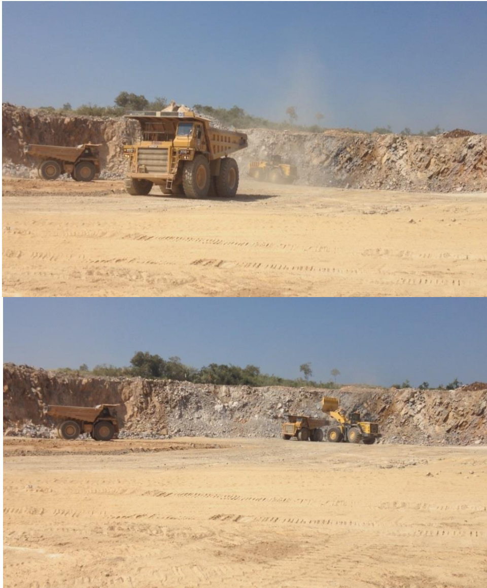
รูปที่ 3-12 แสดงขั้นตอนการทำงานของรถตักและรถบรรทุกในระบบปฏิบัติการขนส่ง
