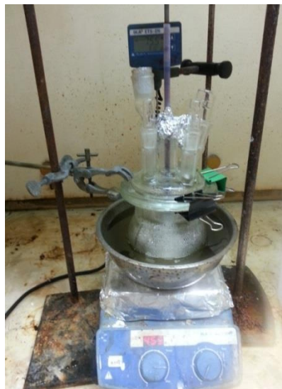
รูปที่ 3.9 การทำปฏิกิริยาของเซลลูโลสไมโครไฟบริลแอซิเตต
