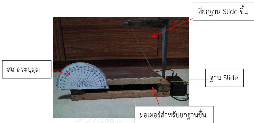
รูปที่ 14 Slide angle tester ที่ใช้ในงานวิจัย
