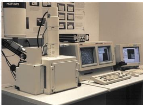
รูปที่ 17 กล้องจุลทรรศน์อิเล็กตรอนแบบส่องกราดที่ใช้ในงานวิจัย
